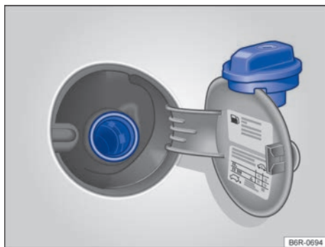
Fig. 144 Portinhola do tanque de combustível aberta com a tampa do tanque de combustível pendurada.
