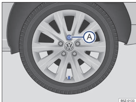
Fig. 196 Troca de roda: sequência de remoção dos parafusos da roda.
