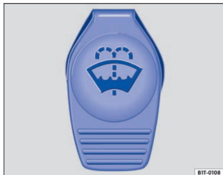
Fig. 177 No compartimento do motor: tampa do reservatório de água dos lavadores dos vidros.
