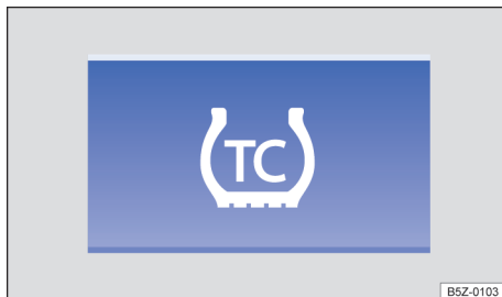
Fig. 98 No console central: botão para desligar e ligar TC (controle de tração) manualmente.
