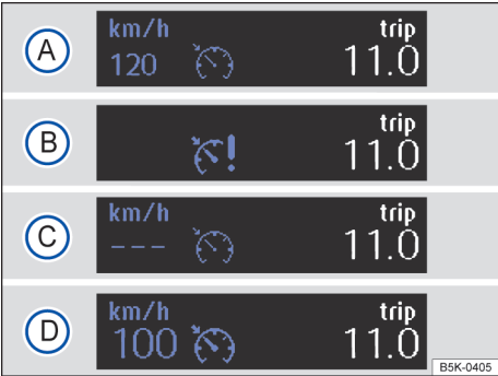
Fig. 89 No display do instrumento combinado: indicadores de status do GRA.
