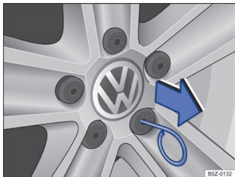
Fig. 192 Retirar as capas de cobertura dos parafusos da roda.
