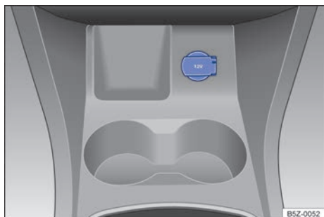
Fig. 108 No console central dianteiro: tomada 12 V.
