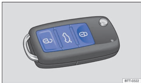
Fig. 47 Botões na chave do veículo com comando remoto.
