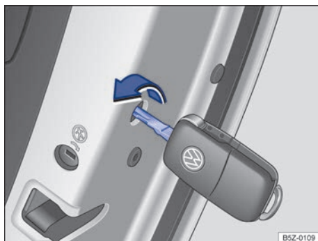
Fig. 53 Travamento de emergência do veículo com a chave do veículo.
