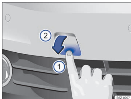
Fig. 169 No para-choque dianteiro à direita: soltar e remover a cobertura.
