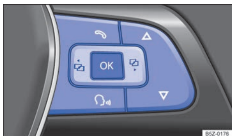
Fig. 18 Lado direito do volante multifunções: botões para comando dos menus do instrumento combinado.
