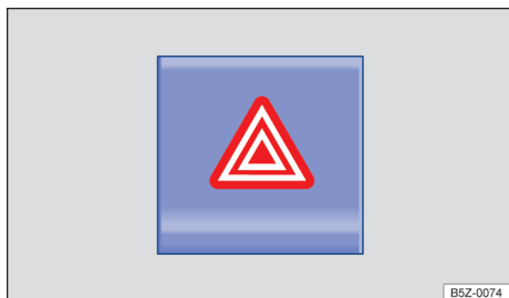
Fig. 38 Na parte superior do console central: interruptor para ligar e desligar as luzes de advertência.
