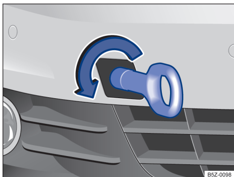
Fig. 137 No para-choque dianteiro à direita: rosquear a argola de reboque.
