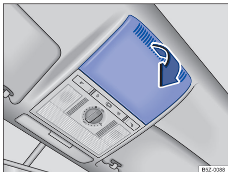
Fig. 56 No revestimento do teto: remover a cobertura.
