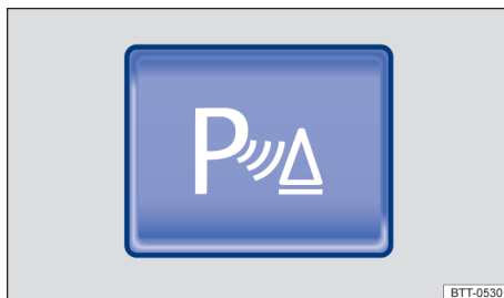
Fig. 90 Na parte superior do console central: botão para ligar e desligar o controle de distância de estacionamento (Park Pilot).
