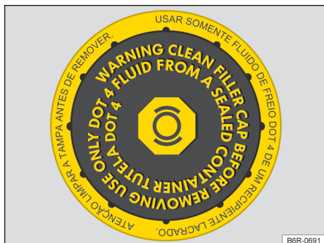
Fig. 149 No compartimento do motor: tampa do reservatório de fluido de freio (variante 1).
