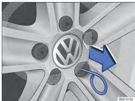
Fig. 178 Retirar as capas de cobertura dos parafusos da roda.
