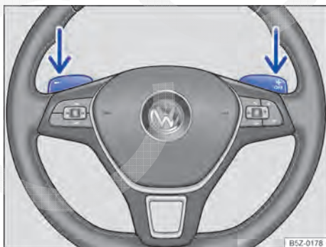
Fig. 99 Volante com dois seletores para troca de marcha no modo manual.
