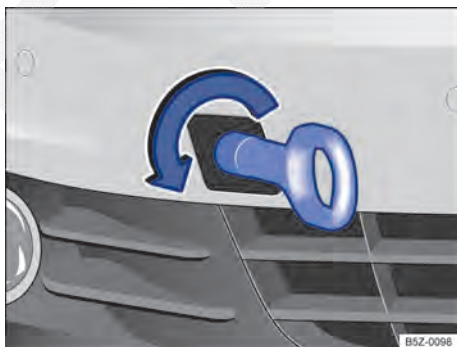
Fig. 156 No para-choque dianteiro à direita: rosquear a argola de reboque.
