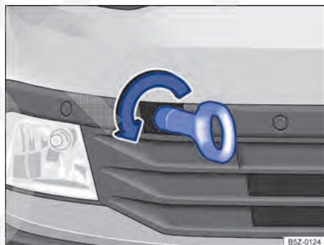
Fig. 158 No para-choque dianteiro à direita: rosquear a argola de reboque.
