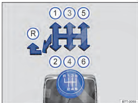
Fig. 95 Esquema de troca de marchas da transmissão manual de 6 marchas.
