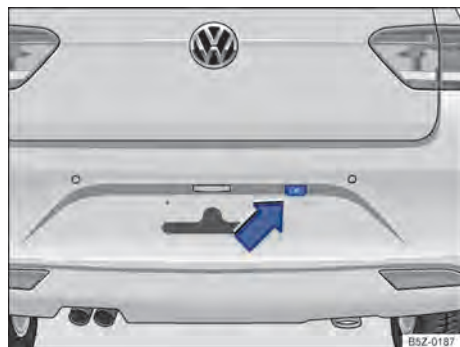
Fig. 108 No para-choque traseiro: local de instalação do assistente de condução em marcha a ré.
