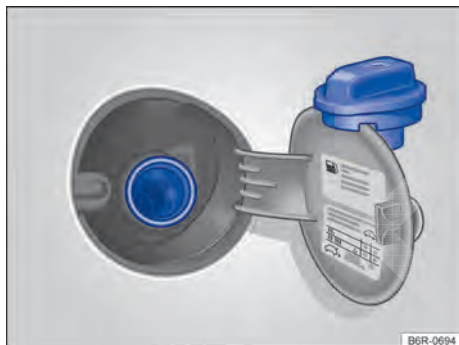
Fig. 129 Portinhola do tanque de combustível aberta com a tampa do tanque de combustível pendurada.
