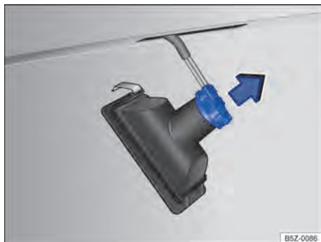
Fig. 146 Lanterna da placa de licença: remover o soquete da lâmpada.
