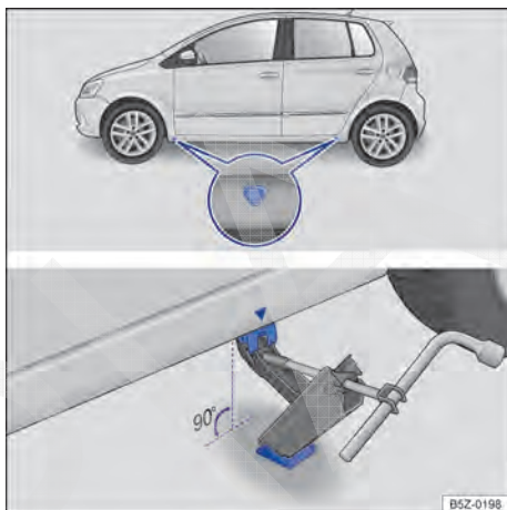
Fig. 181 Pontos de apoio do macaco e macaco posicionado no lado esquerdo traseiro do veículo.
