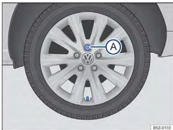
Fig. 167 Troca de roda: sequência de remoção dos parafusos da roda.
