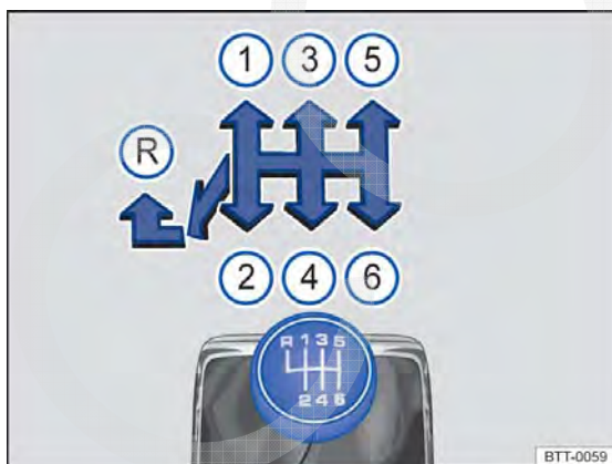
Fig. 100 Esquema de troca de marchas da transmissão manual de 6 marchas.
