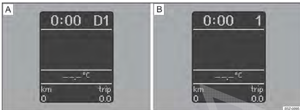
Fig. 103 (A) Posições da alavanca seletora no display: indicação da alavanca no modo de condução automatizada (Modo normal), com a 1ª marcha engatada. (B) Posições da alavanca seletora no display: modo de condução manual, com a 1ª marcha selecionada.
