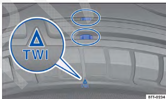
Fig. 142 Perfil do pneu: indicadores de desgaste.
