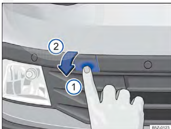
Fig. 189 No para-choque dianteiro à direita: soltar e remover a cobertura.
