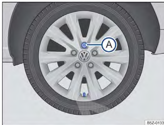
Fig. 164 Retirar a calota integral.
