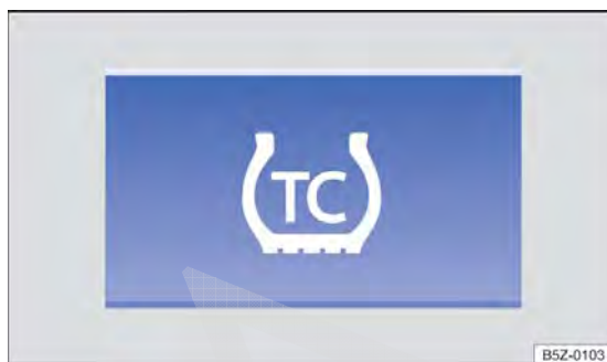
Fig. 111 No console central: botão para desligar e ligar TC (controle de tração) manualmente.
