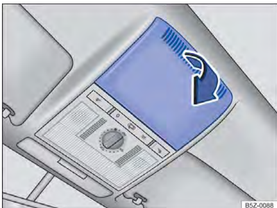
Fig. 158 No revestimento do teto: remover a cobertura.
