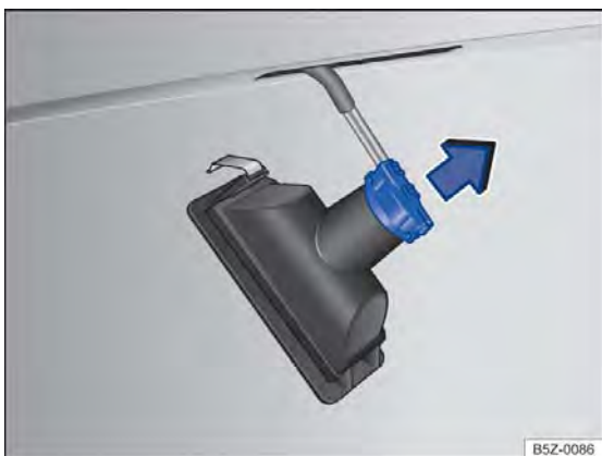
Fig. 184 Lanterna da placa de licença: remover o soquete da lâmpada.
