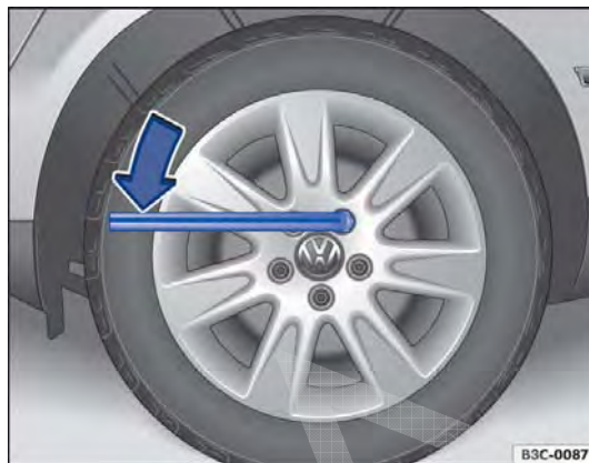
Fig. 165 Troca de roda: soltar os parafusos da roda.
