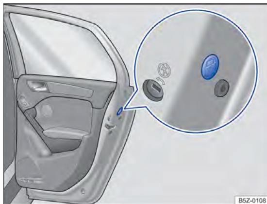
Fig. 155 Na porta traseira: travamento de emergência, coberto por uma vedação de borracha.
