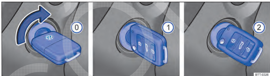
Fig. 91 Ao lado do volante, à direita: posições da chave do veículo no cilindro da ignição.
