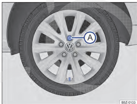
Fig. 148 Troca de roda: sequência de remoção dos parafusos da roda.
