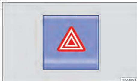
Fig. 156 Na parte superior do console central: interruptor para ligar e desligar as luzes de advertência.
