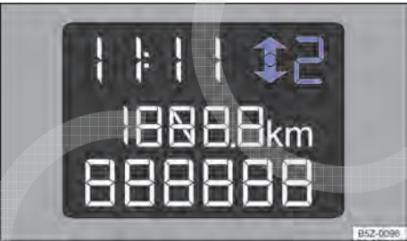
Fig. 97 No instrumento combinado: indicador de troca de marcha (variante 2).
