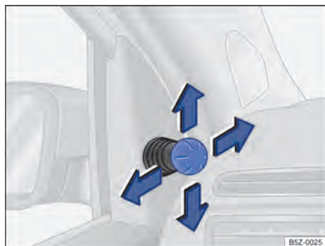
Fig. 69 Nas portas dianteiras: botão de ajuste dos espelhos retrovisores externos mecânicos.
