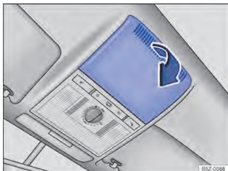
Fig. 163 No revestimento do teto: remover a cobertura.
