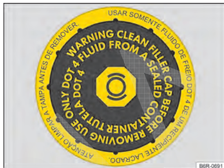
Fig. 107 No compartimento do motor: tampa do reservatório de fluido de freio (variante 1).
