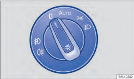
Fig. 58 No painel: interruptor das luzes.
