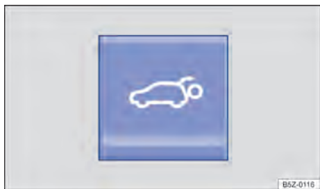
Fig. 27 Na parte superior do console central: interruptor de destravamento do suporte da roda de emergência para abertura da tampa traseira.
