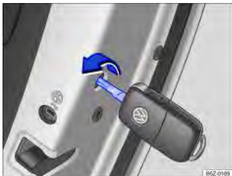
Fig. 155 Travamento de emergência do veículo com a chave do veículo.
