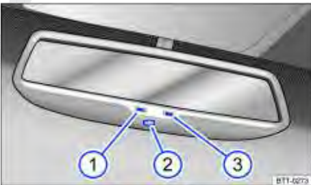
Fig. 71 No para-brisa: espelho retrovisor interno com antiofuscante automático.
