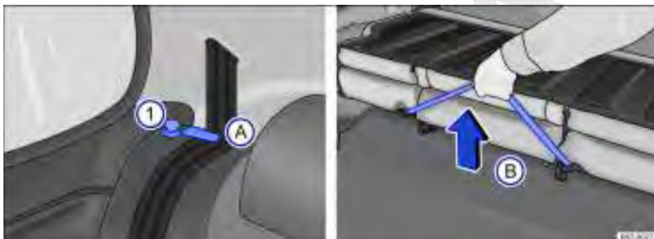
Fig. 74 Banco traseiro: pinos de destravamento ①; posicionador para os caderços dos cintos (A); alça para destravamento do conjunto do assoalho (B).
