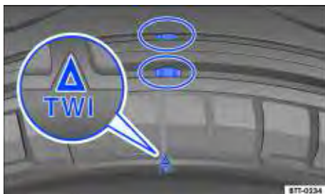
Fig. 140 Perfil do pneu: indicadores de desgaste.
