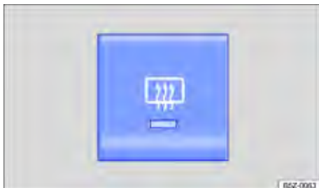
Fig. 123 No console central: botão do desembaçador do vidro traseiro.
