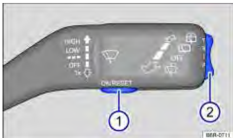
Fig. 12 Veículos sem volante multifunções: tecla ① na alavanca dos limpadores do para-brisa para confirmação dos itens de menu e chave ② para alternar entre os menus.
