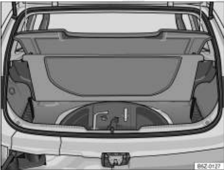
Fig. 159 No compartimento de bagagem embaixo do revestimento do assoalho: ferramentas de bordo.
