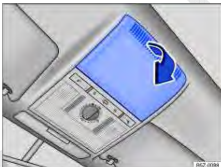
Fig. 157 No revestimento do teto: remover a cobertura.
