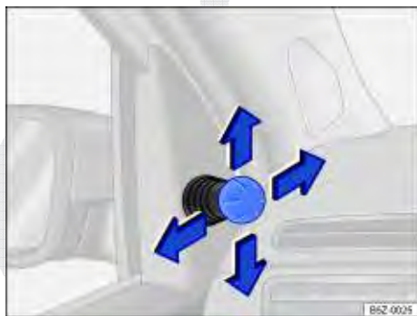
Fig. 72 Nas portas dianteiras: botão de ajuste dos espelhos retrovisores externos mecânicos.
