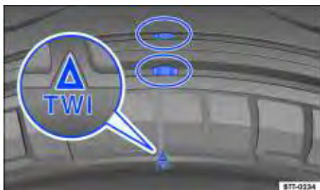
Fig. 139 Perfil do pneu: indicadores de desgaste.
