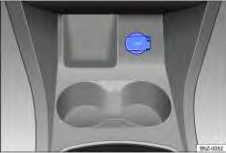
Fig. 91 No console central dianteiro: tomada 12 V.
