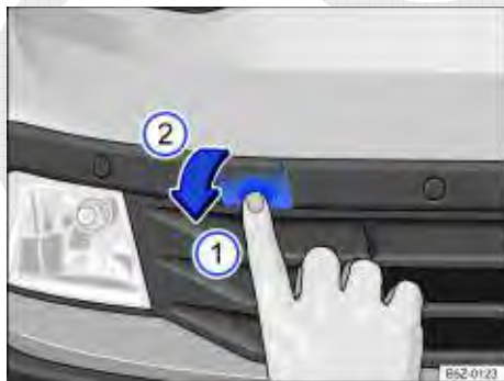
Fig. 185 No para-choque dianteiro à direita: soltar e remover a cobertura.
