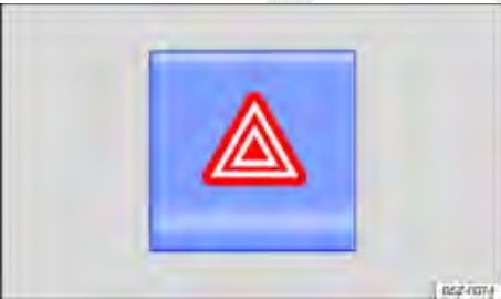
Fig. 147 Na parte superior do console central: interruptor para ligar e desligar as luzes de advertência.
