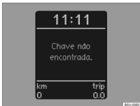
Fig. 94 No instrumento combinado: display com indicação do imobilizador ativado - veículos com Sistema de Informações Volkswagen.
