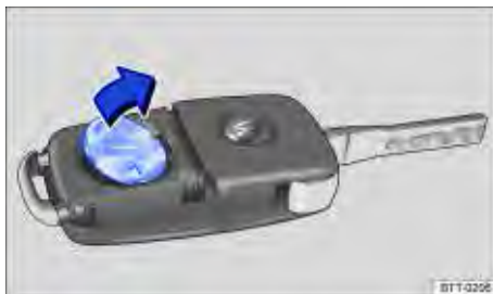
Fig. 24 Chave do veículo com comando remoto: remover a bateria.
