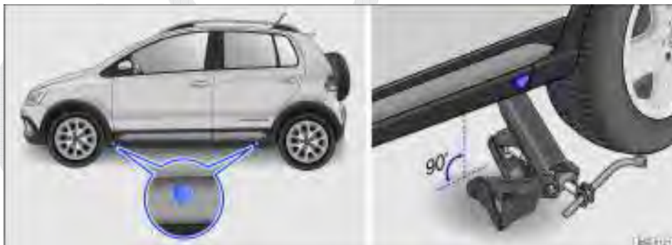
Fig. 165 Pontos de apoio do macaco e macaco posicionado no lado esquerdo traseiro do veículo.
