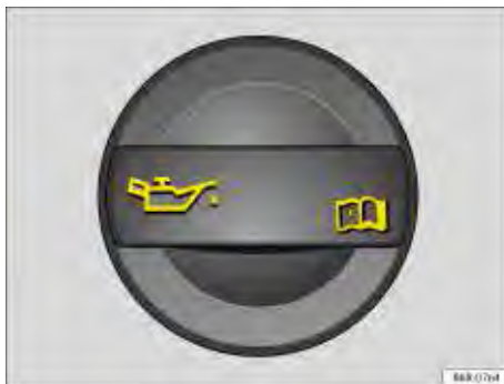
Fig. 128 No compartimento do motor: tampa da abertura para enchimento de óleo do motor.
