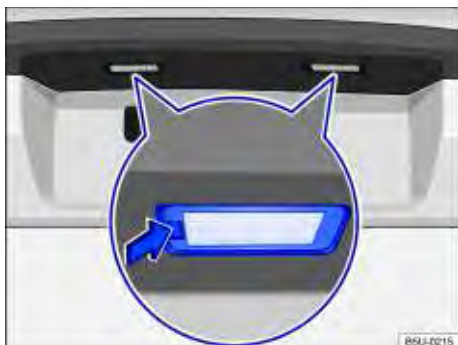
Fig. 181 No para-choque traseiro: remover a lanterna da placa de licença.
