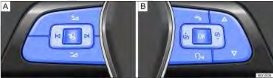
Fig. 16 Volante multifunções: teclas de comando (variante 2)
