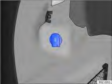
Fig. 92 No compartimento de bagagem: tomada 12 V.
