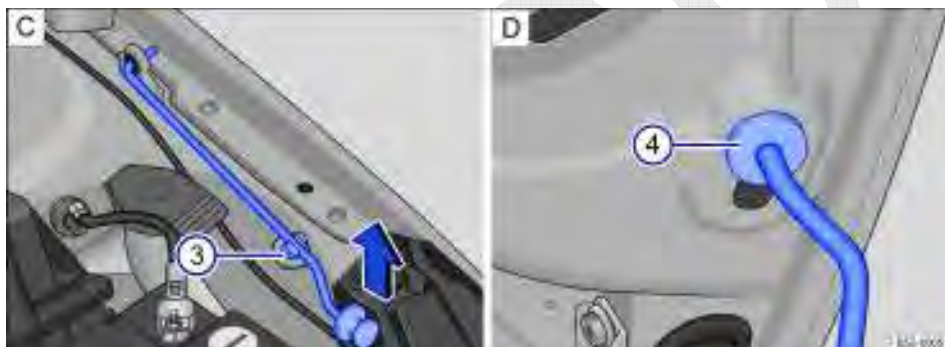
Fig. 126 C: haste de sustentação da tampa do compartimento do motor (3). D: tampa do motor protegida com a haste de sustentação da tampa (4).
