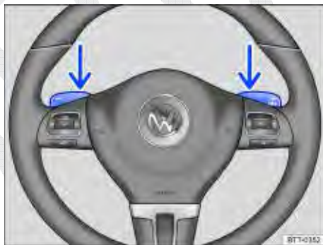
Fig. 103 Volante com dois seletores para troca de marcha no modo manual.
