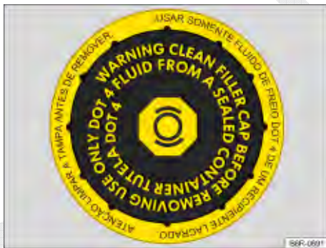
Fig. 109 No compartimento do motor: tampa do reservatório de fluido de freio.
