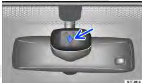
Fig. 67 No para-brisa: superfície sensível do sensor de chuva.
