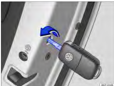
Fig. 154 Travamento de emergência do veículo com a chave do veículo.
