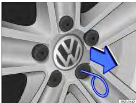
Fig. 162 Retirar as capas de cobertura dos parafusos da roda.
