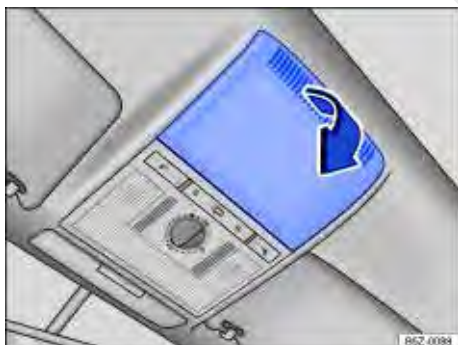
Fig. 156 No revestimento do teto: remover a cobertura.
