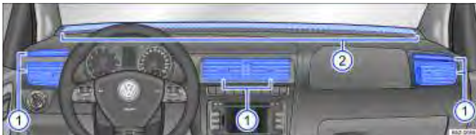
Fig. 121 No painel de instrumentos: difusores de ar.
