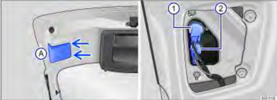
Fig. 179 Lanterna traseira: A desinstalar a cobertura e 1 e 2 desinstalar a lâmpada
