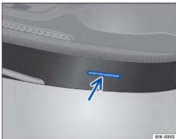
Fig. 264 No para-brisa: número de identificação do veículo.
