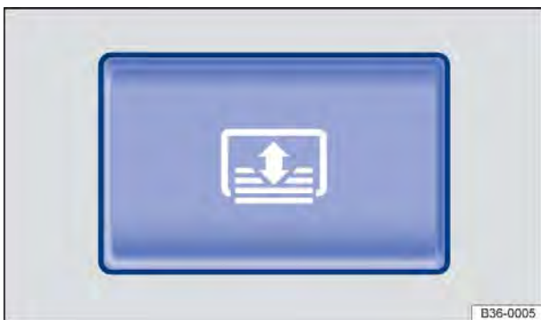
Fig. 85 No console central: interruptor da cortina de proteção solar do vidro traseiro.
