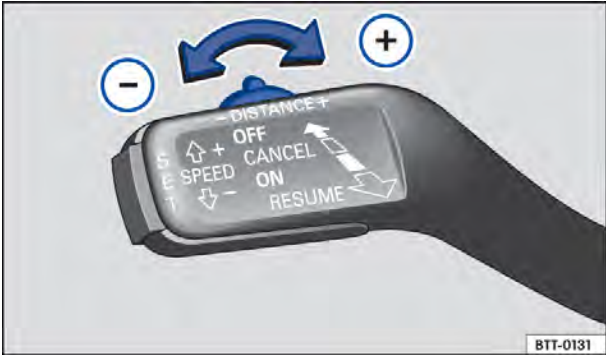
Fig. 169 Alavanca de operação ACC à esquerda na coluna de direção: ajustar o nível de distância.
