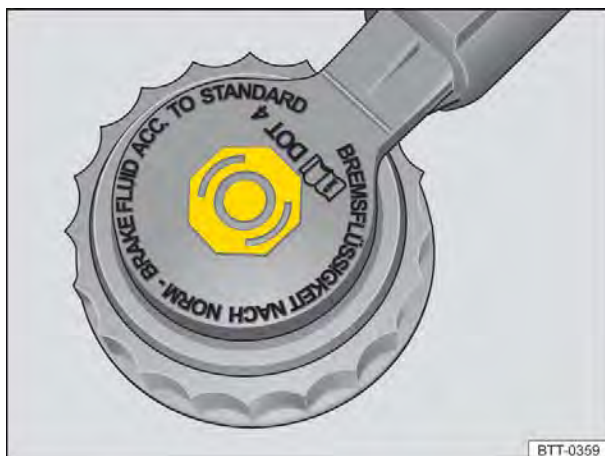
Fig. 144 No compartimento do motor: tampa do reservatório do fluido de freio.
