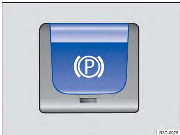
Fig. 142 Na parte inferior do console central: botão do freio de estacionamento eletrônico.
