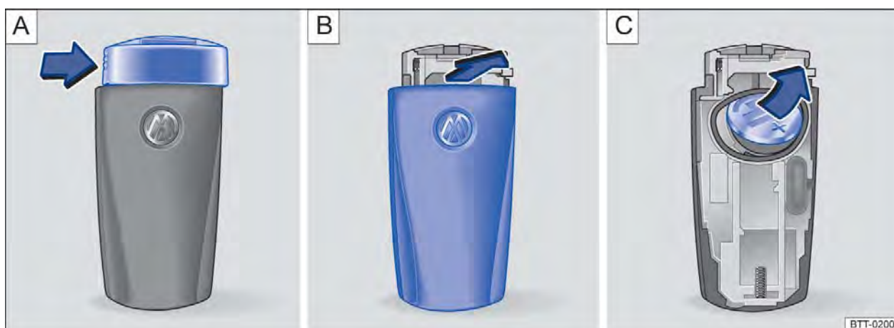
Fig. 22 Abrir a cobertura da bateria da chave do veículo.
