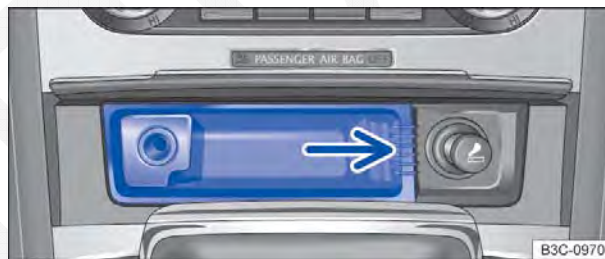
Fig. 124 No console central dianteiro: remover o cinzeiro.
