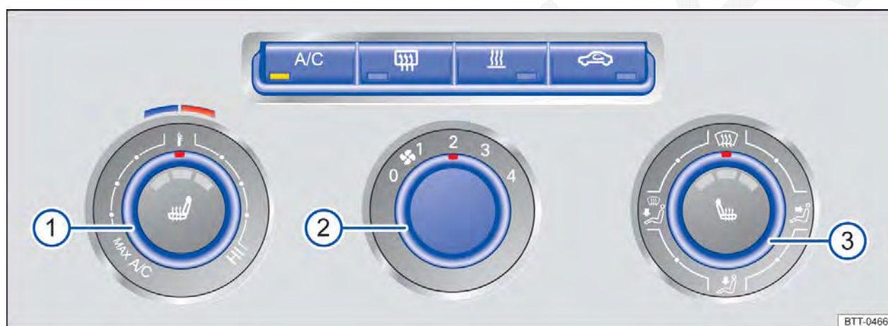
Fig. 182 No console central: comandos do ar-condicionado (manual).
