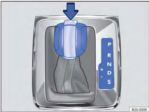
Fig. 139 Veículos com direção à direita: alavanca seletora da transmissão automática com botão bloqueador (seta).
