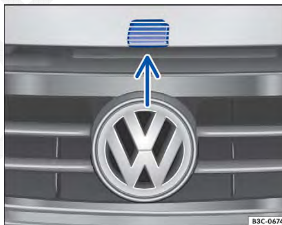
Fig. 196 Acima da grade do radiador: alavanca de abertura da tampa de compartimento do motor
