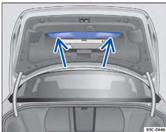
Fig. 33 Tampa do compartimento de bagagem aberta: rebaixas para puxar.
