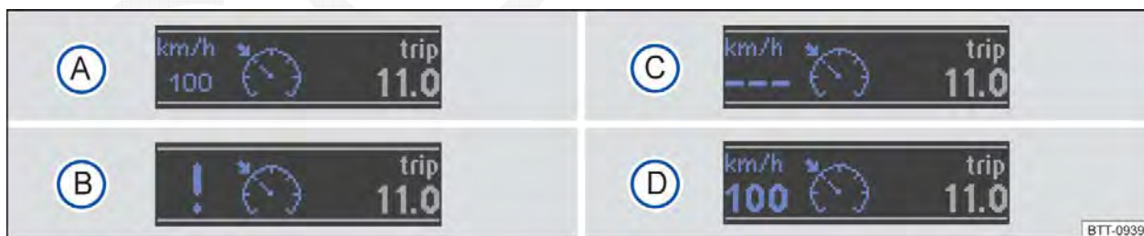
Fig. 164 No display do instrumento combinado: indicadores de status do GRA.
