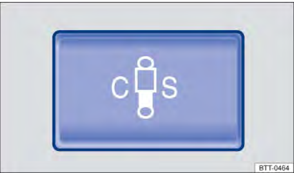
Fig. 181 No console central: botão de ajuste da regulagem dinâmica da suspensão.
