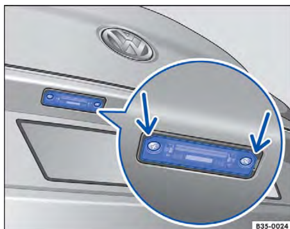
Fig. 254 No para-choque traseiro: lanterna da placa de licença.
