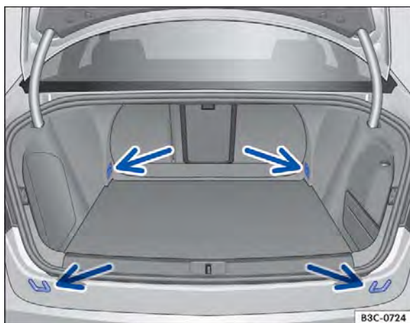
Fig. 97 No compartimento de bagagem: olhais de amarração.
