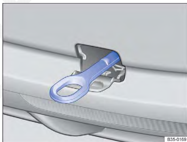
Fig. 262 No para-choque traseiro à direita: argola de reboque rosqueada.
