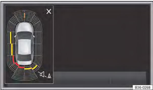
Fig. 150 Exibição do display da vista em miniatura nos arredores do veículo.
