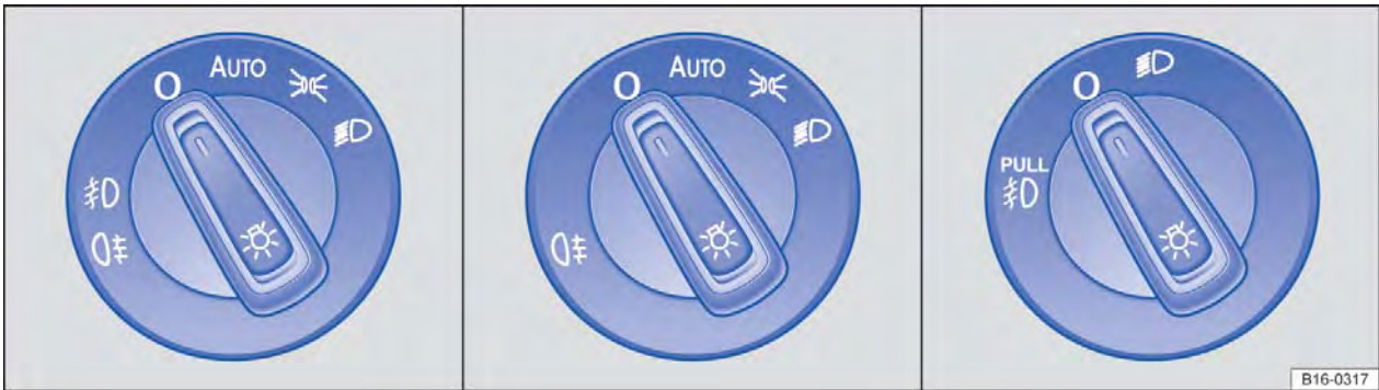
Fig. 81 Ao lado do volante: interruptor das luzes (representação de algumas variantes).
