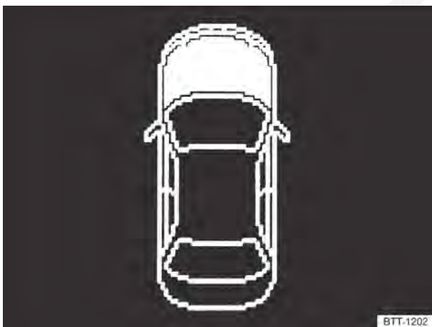
Fig. 194 Representação esquemática do display do instrumento combinado: tampa do compartimento do motor aberta ou fechada incorretamente.
