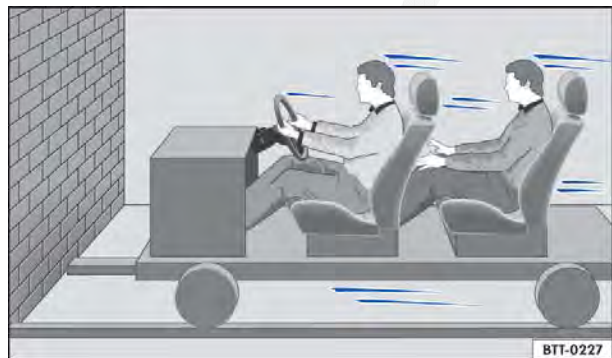
Fig. 59 Um veículo com os ocupantes do veículo sem cintos de segurança está em rota de colisão com um muro.
