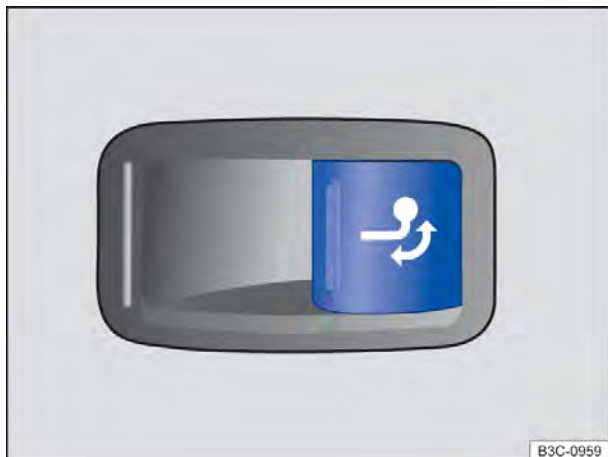
Fig. 105 No compartimento de bagagem, à direita: botão para destravamento da rótula de engate.
