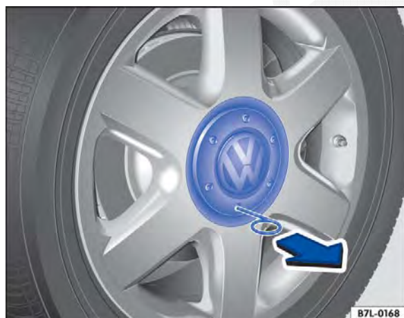
Fig. 228 Retirar a calota central.
