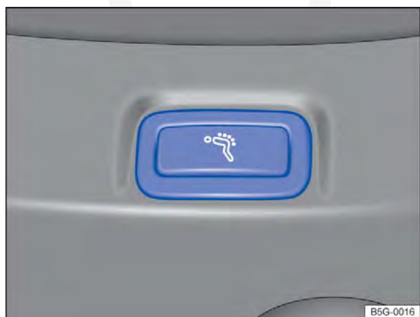
Fig. 53 Na região inferior do banco do condutor: botão da função de massagem para as costas.
