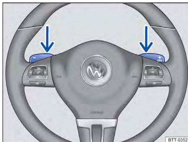
Fig. 141 Volante com 2 seletores basculantes do Tiptronic.
