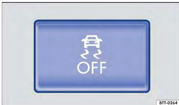
Fig. 148 No console central: botão para desligar e ligar o ASR manualmente.
