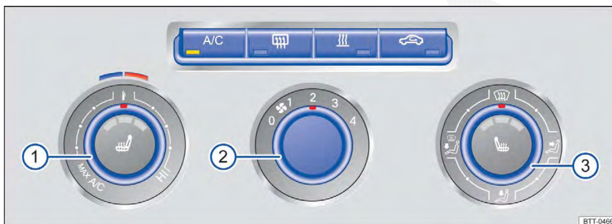
Fig. 186 No console central: comandos do ar-condicionado (manual).
