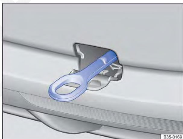
Fig. 262 No para-choque traseiro à direita: argola de reboque rosqueada.
