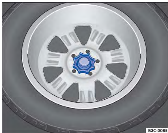
Fig. 211 No compartimento de bagagem: manípulo para fixação da roda sobressalente.
