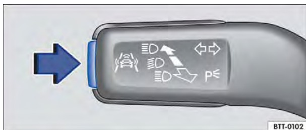
Fig. 16 Na alavanca dos indicadores de direção e do farol alto à esquerda da coluna de direção: botão dos sistemas de assistência ao condutor.
