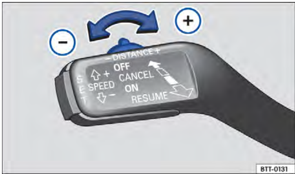
Fig. 171 Alavanca de operação ACC à esquerda na coluna de direção: ajustar o nível de distância.
