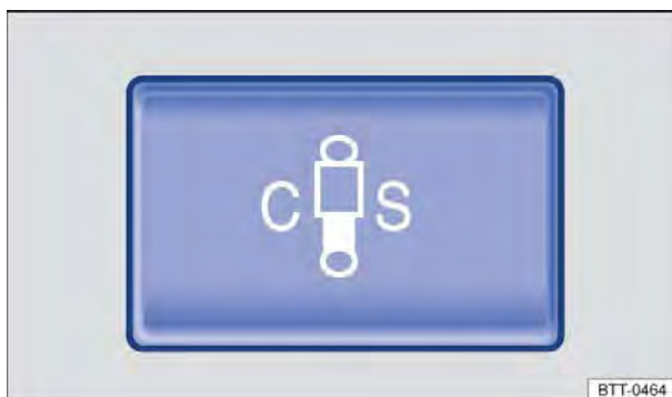
Fig. 184 No console central: botão de ajuste da regulagem dinâmica da suspensão.
