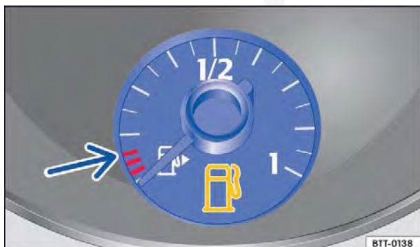
Fig. 191 No instrumento combinado: indicador do nível de combustível para gasolina e óleo diesel.
