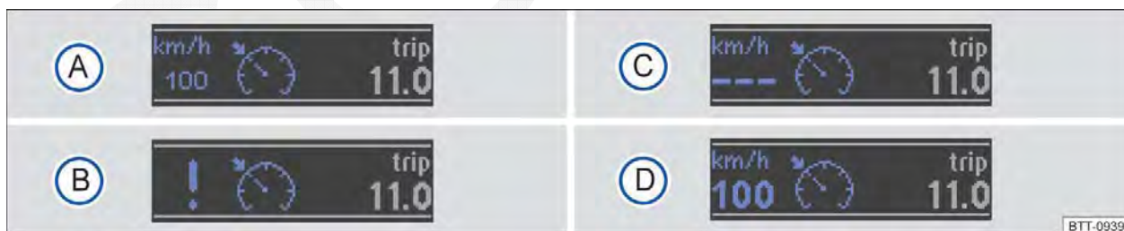
Fig. 166 No display do instrumento combinado: indicadores de status do GRA.
