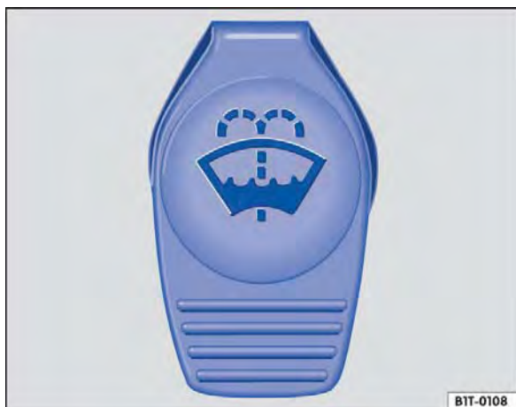
Fig. 94 No compartimento do motor: tampa do reservatório de água dos lavadores dos vidros.
