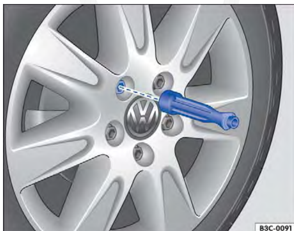
Fig. 238 Troca de roda: desaparafusar os parafusos de roda com o punho da chave de fenda.
