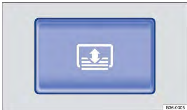
Fig. 88 No console central: interruptor da cortina de proteção solar do vidro traseiro.
