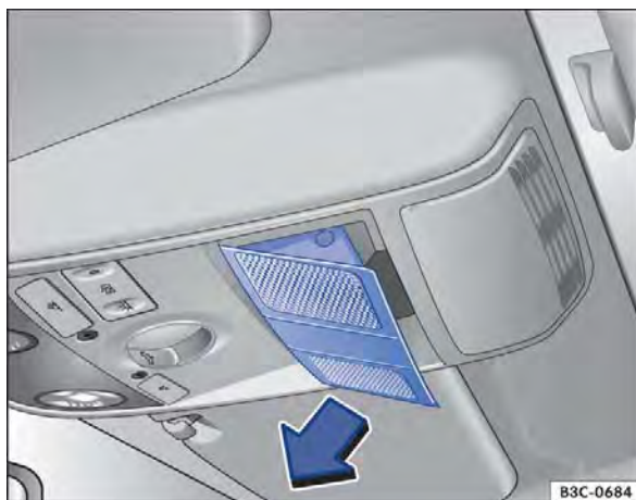
Fig. 222 No revestimento do teto: remover a cobertura.
