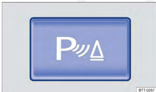
Fig. 154 Na parte inferior do console central: botão para ligar e desligar o Park Pilot.
