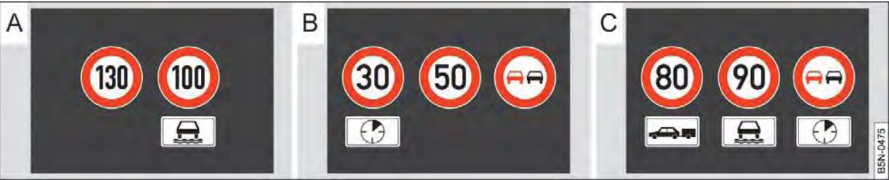
Fig. 182 No display do instrumento combinado: exemplos de limites de velocidade e proibição de ultrapassagem com placas adicionais associadas.
