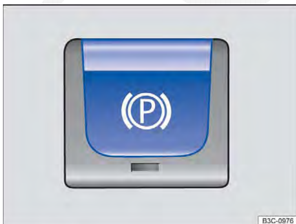
Fig. 147 Na parte inferior do console central: botão do freio de estacionamento eletrônico.
