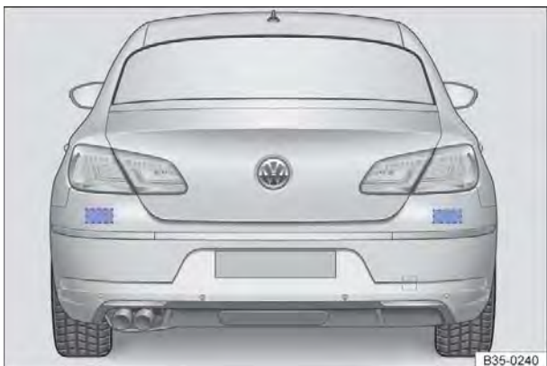
Fig. 179 Vista traseira do veículo: área dos sensores do radar.
