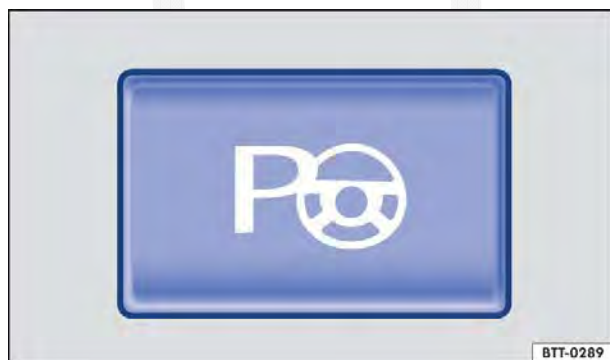
Fig. 162 Na parte inferior do console central: botão para ligar o assistente de direção para estacionamento.
