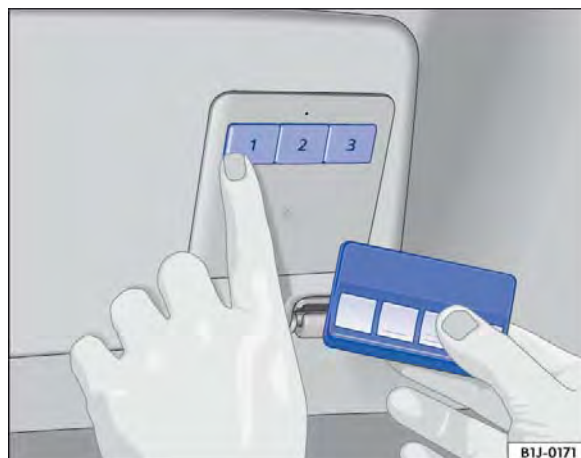
Fig. 40 Para programar: Pressionar ao mesmo tempo tecla para o controle de porta de garagem e o controle remoto.
