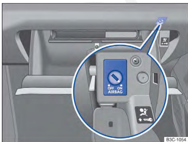
Fig. 75 No porta-luvas: interruptor acionado pela chave para desligar e ligar o airbag frontal do passageiro.
