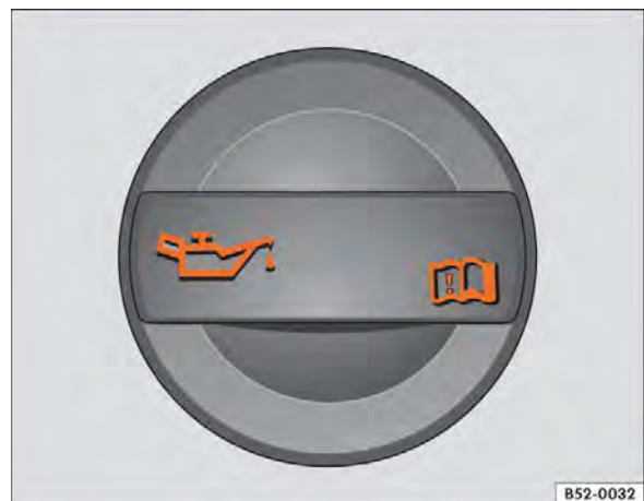
Fig. 199 No compartimento do motor: tampa da abertura de enchimento de óleo do motor.
