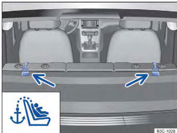
Fig. 82 Olhais de fixação para o assento externo na superfície atrás do banco traseiro.
