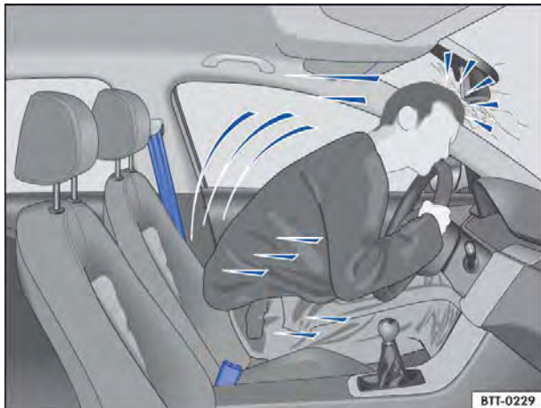
Fig. 64 O condutor sem cinto de segurança é lançado para frente.
