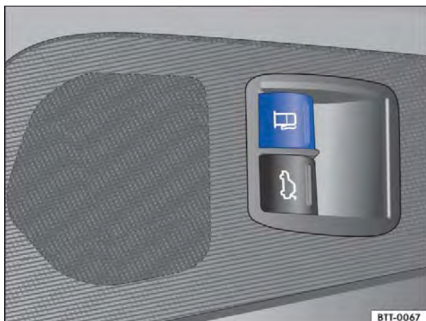
Fig. 192 Na porta do condutor: botão de destravamento da tampa de combustível.
