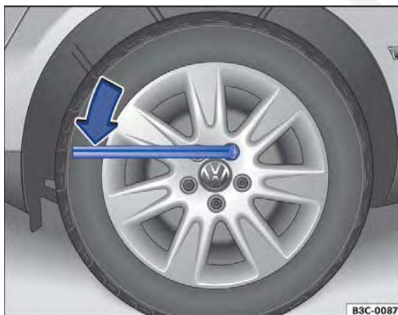
Fig. 232 Troca de roda: Afrouxar os parafusos de roda.
