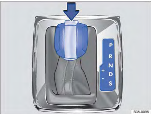
Fig. 144 Veículos com direção à direita: alavanca seletora da transmissão automática com botão bloqueador (seta).
