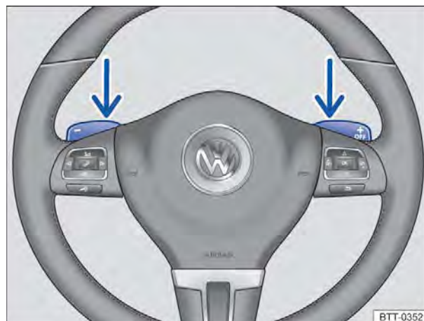
Fig. 146 Volante com 2 seletores basculantes do Tiptronic.
