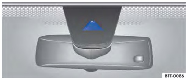
Fig. 177 No para-brisa: visor da câmera do assistente de permanência na faixa.
