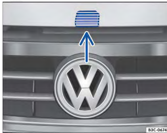
Fig. 197 Em cima da grade do radiador: alavanca de destravamento para abrir a tampa do compartimento do motor.
