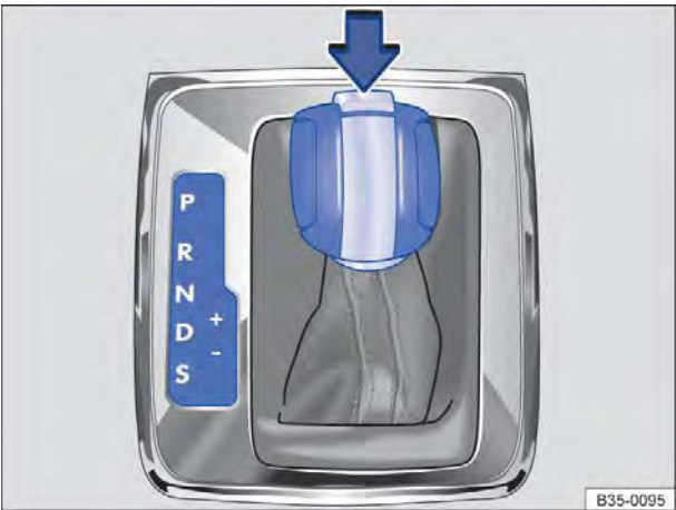
Fig. 143 Veículos com direção à esquerda: alavanca seletora da transmissão automática com botão bloqueador (seta).
