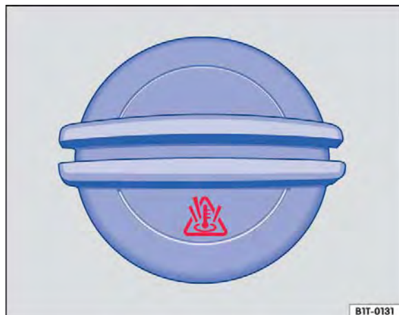
Fig. 202 No compartimento do motor: tampa do reservatório do líquido de arrefecimento do motor.
