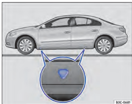
Fig. 230 Pontos de apoio do macaco.
