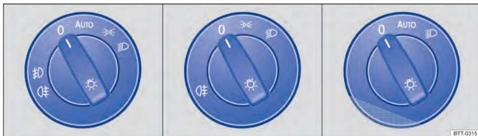
Fig. 84 Ao lado do volante: interruptor das luzes (representação de algumas variantes).
