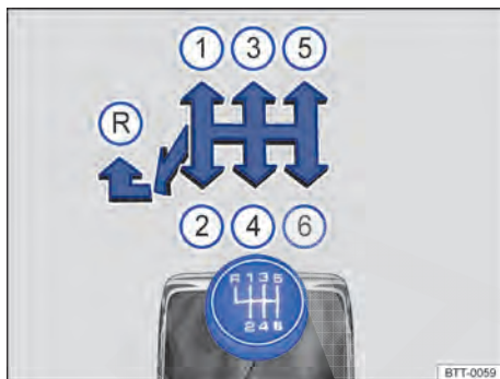
Fig. 142 Esquema de troca de marchas da transmissão manual de 6 marchas.
