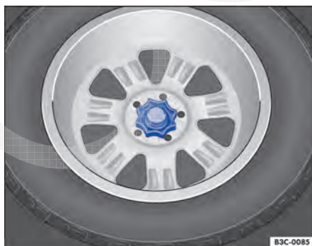
Fig. 207 No compartimento de bagagem: manípulo para fixação da roda sobressalente.
