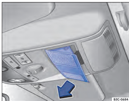
Fig. 218 No revestimento do teto: remover a cobertura.
