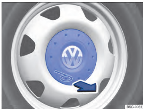
Fig. 174 Retirar a calota central.
