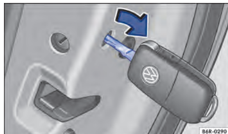
Fig. 170 Travamento de emergência do veículo com a chave do veículo.
