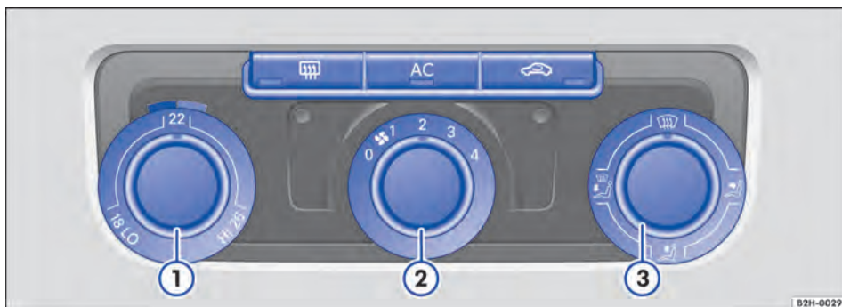
Fig. 127 No painel de instrumentos: comandos do Climatic.
