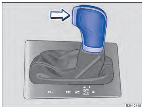
Fig. 113 Veículos com direção à esquerda: alavanca seletora da transmissão automática com botão bloqueador (seta).
