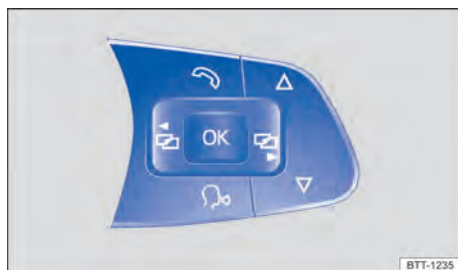
Fig. 14 Veículos com volante multifunções: botões para comandar os menus no instrumento combinado.
