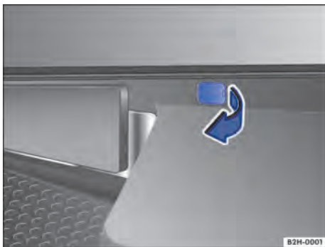
Fig. 176 Capa de cobertura no para-choque.
