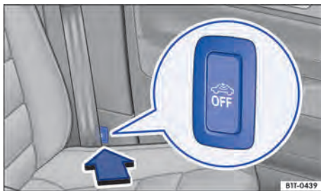
Fig. 21 Ao lado do banco do condutor na coluna B: botão para desligar o monitoramento do interior do veículo e o alarme antirrebocagem.
