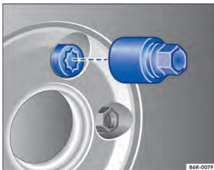
Fig. 181 Troca de roda: parafusos de roda antifurto e adaptador.
