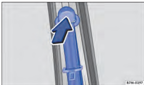
Fig. 64 Ao lado dos bancos dianteiros: regulagem de altura do cinto de segurança.
