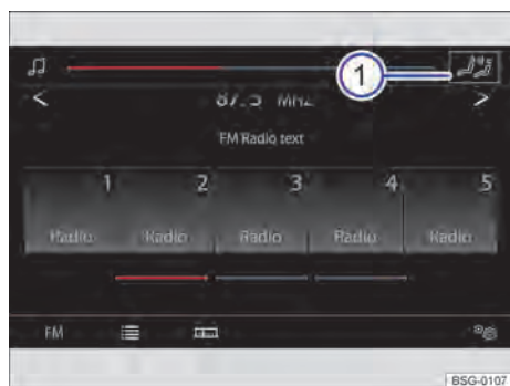
Fig. 108 Exibição do display no console central: superfície de função para acessar o amplificador de voz eletrônico.
