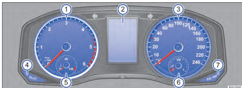
Fig. 12 Instrumento combinado no painel de instrumentos.
