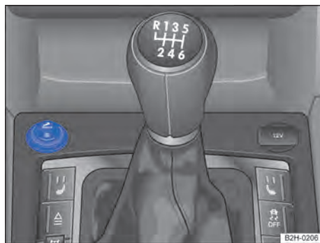
Fig. 105 No console central: acendedor de cigarro (veículos com direção à esquerda).
