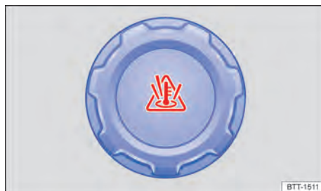
Fig. 153 No compartimento do motor: tampa do reservatório de expansão do líquido de arrefecimento do motor.
