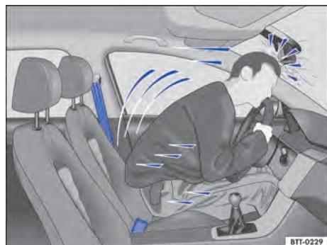
Fig. 53 O condutor sem cinto de segurança é lançado para frente.
