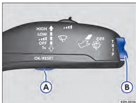
Fig. 13 Veículos sem volante multifunções: botão A na alavanca dos limpadores do para-brisa para confirmar itens de menu e chave B para trocar menus.
