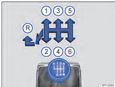
Fig. 112 Esquema de troca de marchas da transmissão manual de 6 velocidades.
