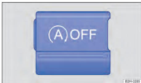
Fig. 120 No console central: botão do sistema Start-Stop.
