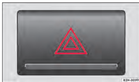
Fig. 167 No centro do painel de instrumentos: botão para ligar e desligar as luzes de advertência. ►
