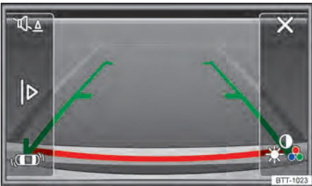
Fig. 123 Exibição do display do sistema Infotainment: câmera de marcha a ré ligada.
