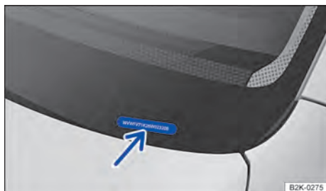
Fig. 212 Número de identificação do veículo.
