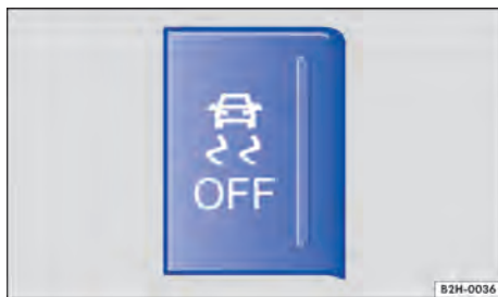
Fig. 117 No console central: botão para desligar e ligar ESC manualmente.
