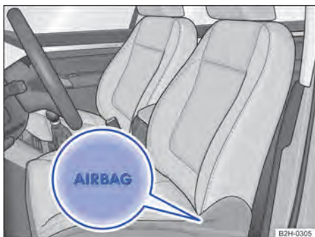
Fig. 70 Na lateral no banco dianteiro: local de instalação do airbag para cabeça e laterais combinado.
