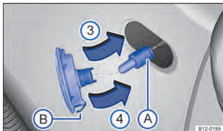
Fig. 202 Lanterna lateral dos indicadores de direção: substituir a lâmpada incandescente.
