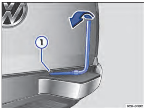
Fig. 177 Girar a roda sobressalente para baixo pelo guincho.
