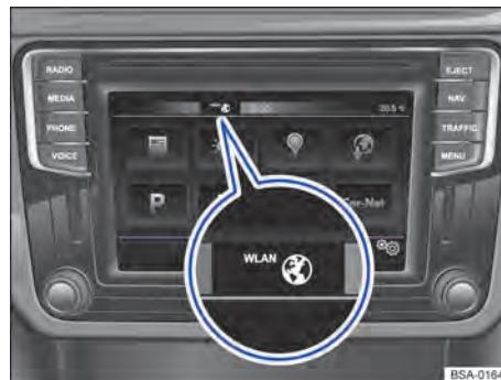
Fig. 120 Na linha de status superior no sistema Infotainment: símbolos do Volkswagen Car-Net.
