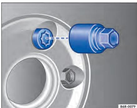
**Fig. 186** Troca de roda: parafusos de roda antifurto e adaptador.
