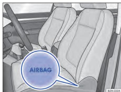
Fig. 37 Na lateral no banco dianteiro: local de instalação do airbag para cabeça e laterais combinado. B2H-0305
