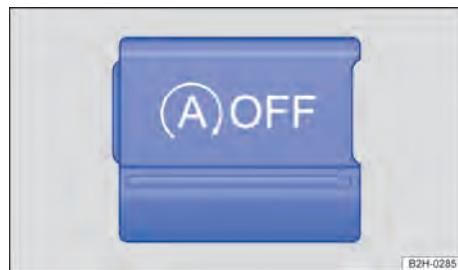
Fig. 92 No console central: botão do sistema Start-Stop.
