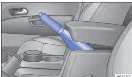
**Fig. 108** Entre os assentos dianteiros: freio de estacionamento.
