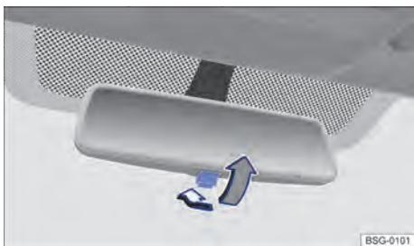
Fig. 81 No para-brisa: espelho retrovisor interno com antifuscante manual.
