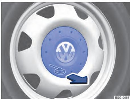
Fig. 183 Retirar a calota central.
