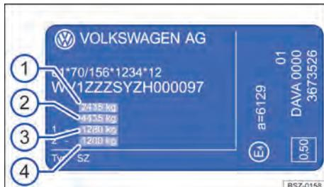
Fig. 206 Na porta dianteira esquerda na coluna B: plaleta de identificação.
