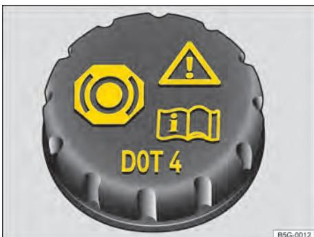
Fig. 174 No compartimento do motor: tampa do reservatório do fluido de freio.
