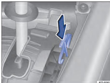
**Fig. 98** destravar emergencialmente o bloqueio da alavanca seletora.
