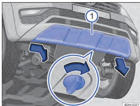
Fig. 161 No para-choque dianteiro: cobertura da argola de reboque.
