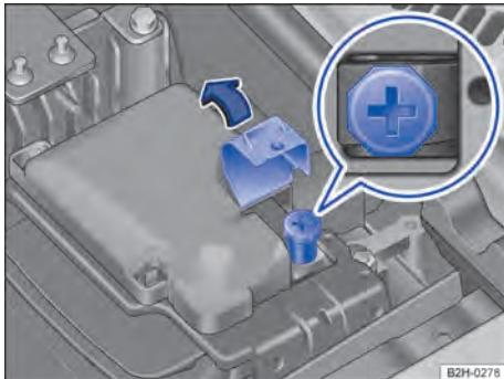
Fig. 158 No compartimento do motor, à esquerda: polo positivo do ponto de auxílio à partida.
