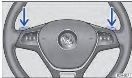
**Fig. 96** Volante com seletores basculantes do Tiptronic.
