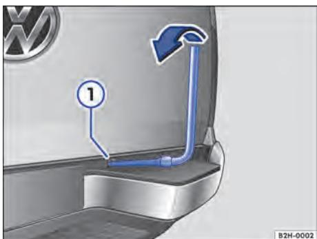
Fig. 194 Colocar a roda sobressalente sobre o guincho.
