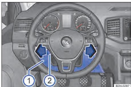
**Fig. 154** No lado do condutor (veículos com direção à esquerda): caixa de fusíveis atrás do revestimento do painel de instrumentos ①.
