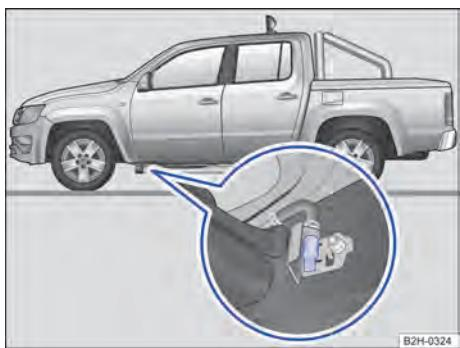
**Fig. 135** Na parte inferior do veículo na longarina: bujão de drenagem do filtro de óleo diesel (dependendo da versão).
