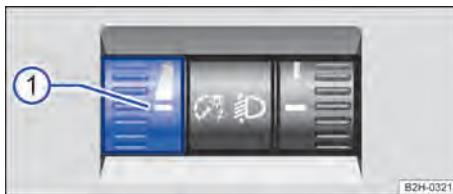
Fig. 75 Ao lado do volante: regulador da iluminação dos instrumentos e dos interruptores ①.
