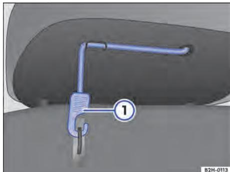
Fig. 59 Sob o banco traseiro: cinta de fixação da superfície do banco.
