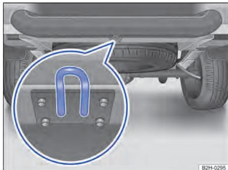
Fig. 160 Abaixo do para-choque: argola de reboque em veículos sem dispositivo de reboque de fábrica.
