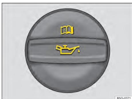
Fig. 170 No compartimento do motor: tampa da abertura para enchimento de óleo do motor (representação esquemática).
