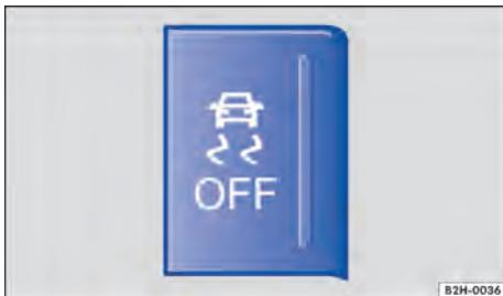
Fig. 112 No controle central: botão para desligar e ligar o ASR manualmente.
