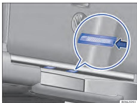
Fig. 149 Na chapa terminal traseira embaixo da tampa do compartimento de carga: lanternas da placa de licença.
