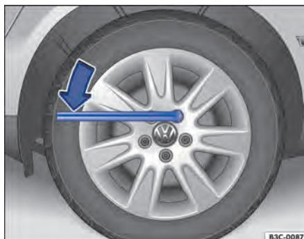
**Fig. 185** Troca de roda: afrouxar os parafusos de roda.
