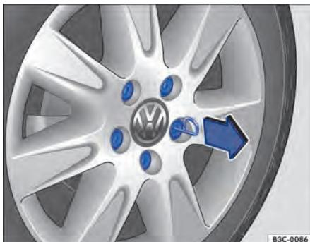
Fig. 184 Remover as capas de cobertura dos parafusos de roda.
