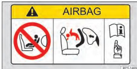
Fig. 40 Representação esquemática: etiqueta do airbag no para-sol.
