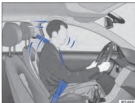
**Fig. 23** Condutor protegido pelo cinto de segurança colocado corretamente numa manobra de frenagem súbita.
