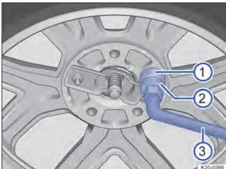
**Fig. 189** Remover o dispositivo antifurto.
