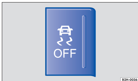
Fig. 117 No controle central: botão para desligar e ligar ASR manualmente.
