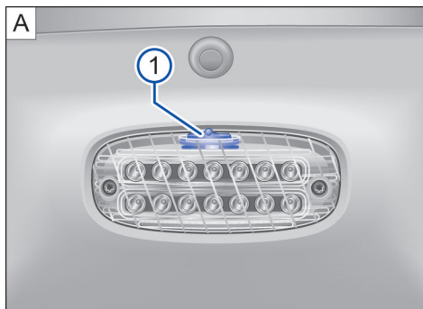
Fig. 79 Interruptor da iluminação da capota rígida do compartimento de carga: A : acima da tampa traseira e B : no lado esquerdo do veículo, perto da tampa traseira.
