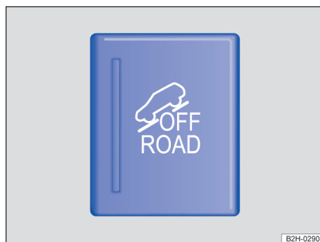
Fig. 104 No console central: botão para ligar e desligar a função off-road manualmente.
