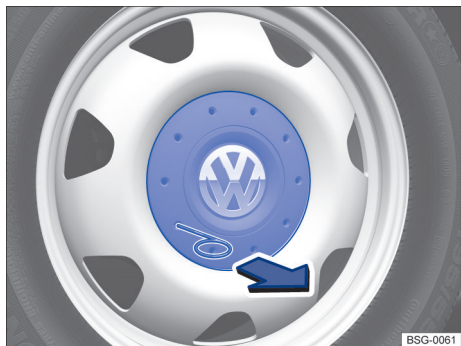
Fig. 192 Retirar a calota central.
