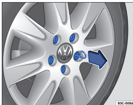
Fig. 193 Remover as capas de cobertura dos parafusos de roda.
