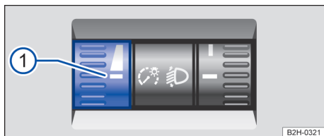
Fig. 77 Ao lado do volante: regulador da iluminação dos instrumentos e dos interruptores ①.
