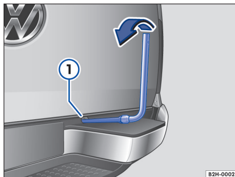
Fig. 187 Girar a roda sobressalente para baixo pelo guincho.
