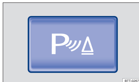
Fig. 114 No console central: botão para ligar ou desligar o auxílio de estacionamento (depende da versão).
