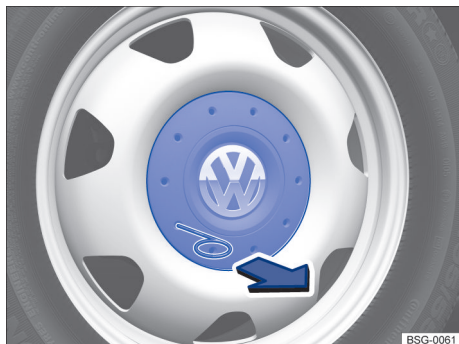
Fig. 194 Retirar a calota central.
