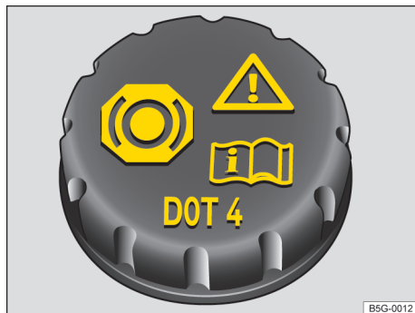
Fig. 180 No compartimento do motor: tampa do reservatório do fluido de freio.
