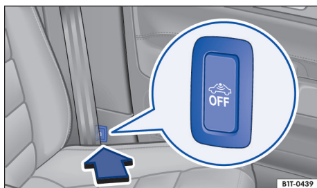
Fig. 51 Ao lado do banco do condutor: botão para desligar o monitoramento do interior do veículo e o alarme antirrebocagem.
