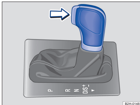
Fig. 102 Veículos com direção à esquerda: alavanca seletora da transmissão automática com botão bloqueador (seta). Em veículos com direção à direita, a disposição dos elementos é espelhada.
