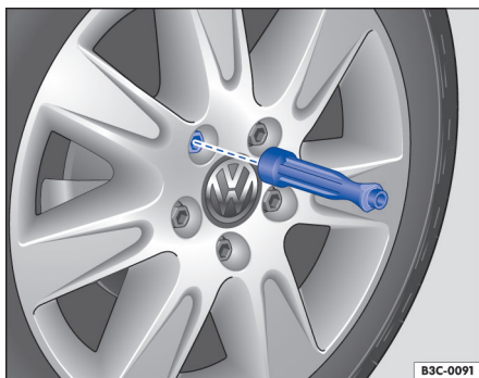
Fig. 203 Troca de roda: desaparafusar os parafusos de roda com o punho da chave de fenda.
