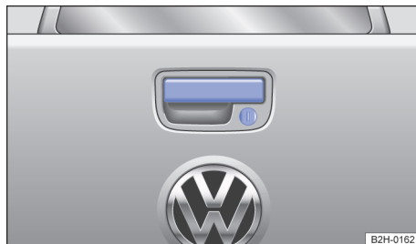
Fig. 52 Alça para abrir a tampa do compartimento de carga.
