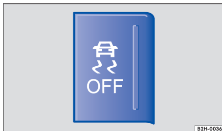
Fig. 118 No controle central: botão para desligar e ligar ASR manualmente.
