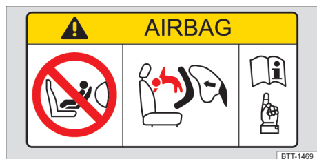
Fig. 41 Representação esquemática: etiqueta do airbag no para-sol.
