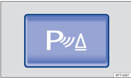
Fig. 115 No console central: botão para ligar ou desligar o auxílio de estacionamento (depende da versão).
