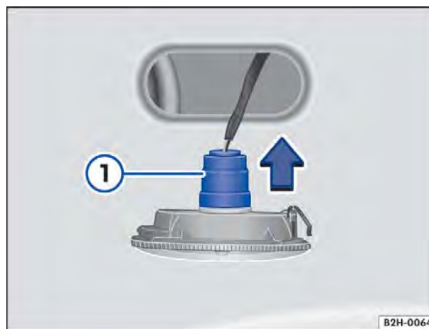
Fig. 178 Lanterna lateral dos indicadores de direção: trocar a lâmpada incandescente.
