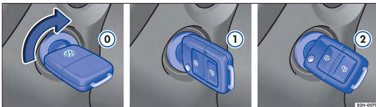
Fig. 98 Posições da chave do veículo no cilindro da ignição.
