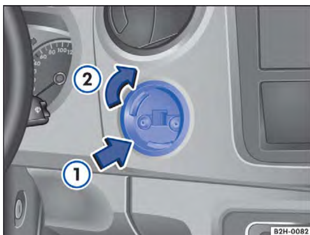
Fig. 90 Posicionar o acessório no ponto de multifixação.
