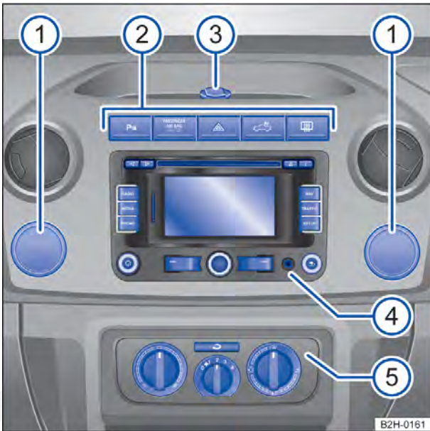
Fig. 8 Vista geral da parte superior do console central (veículos com direção à direita).
