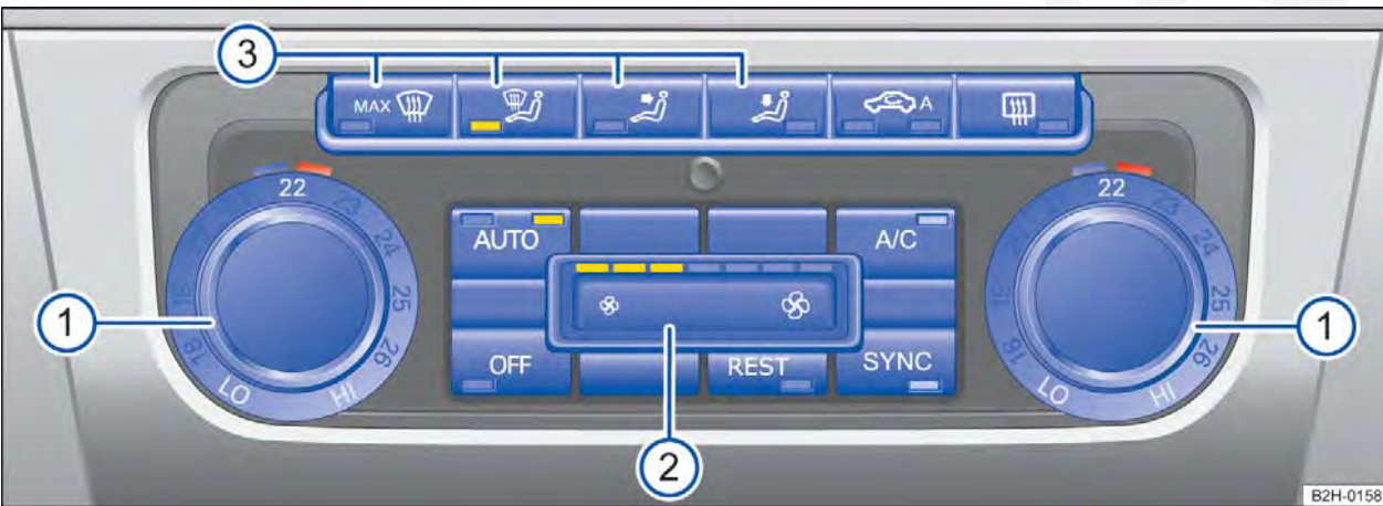
Fig. 122 No painel de instrumentos: comandos do Climatronic.
