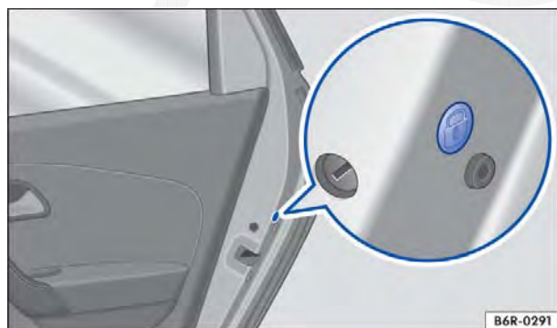
Fig. 146 Na parte dianteira da porta traseira direita: travamento de emergência, coberto por uma vedação de borracha.
