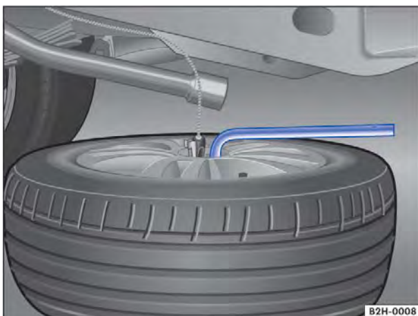
Fig. 153 Desaparafusar o parafuso de segurança com a chave de roda.
