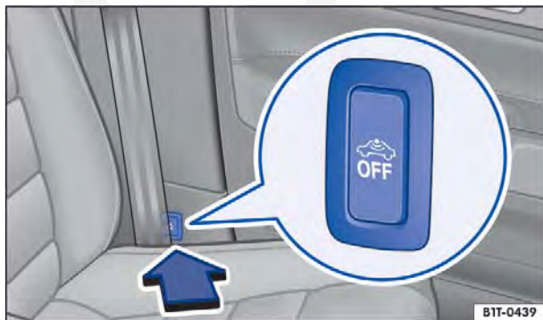
Fig. 25 Ao lado do banco do condutor: botão para desligar o monitoramento do interior do veículo e o alarme antirrebocagem.
