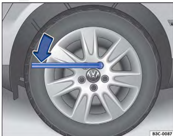
Fig. 156 Troca de roda: soltar os parafusos de roda.
