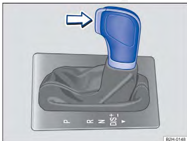
Fig. 102 Veículos com direção à esquerda: alavanca seletora da transmissão automática com botão bloqueador (seta).
