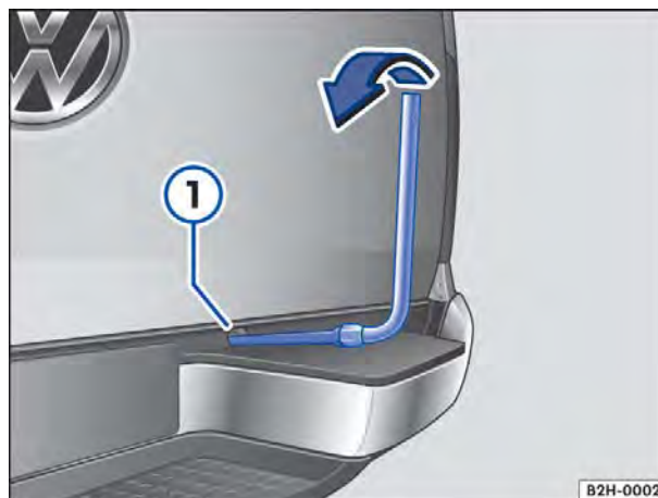
Fig. 152 Girar a roda sobressalente para baixo pelo guincho.
