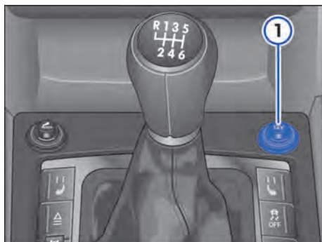
Fig. 96 Direção à esquerda: no console central dianteiro ① (em veículos com direção à direita é espelhado) e no porta-objetos no painel de instrumentos ②: tomada 12 V.
