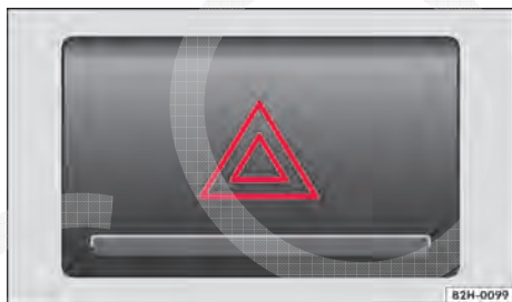
Fig. 143 No centro do painel de instrumentos: botão para ligar e desligar as luzes de advertência.
