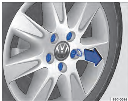
Fig. 149 Remover as capas de cobertura dos parafusos de roda.
