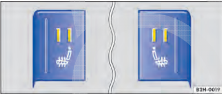
Fig. 41 No console central: botões do aquecimento dos bancos dianteiros.
