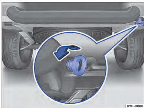
Fig. 185 No para-choque traseiro à direita: argola de reboque rosqueada.
