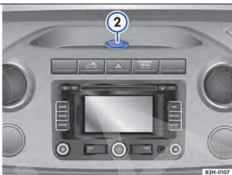
Fig. 96 Direção à esquerda: no console central dianteiro ① (em veículos com direção à direita é espelhado) e no porta-objetos no painel de instrumentos ②: tomada 12 V.
