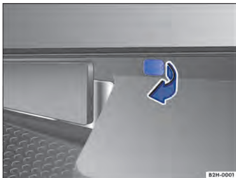
Fig. 150 Capa de cobertura no para-choque.
