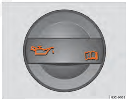
Fig. 133 No compartimento do motor: tampa da abertura para enchimento de óleo do motor.
