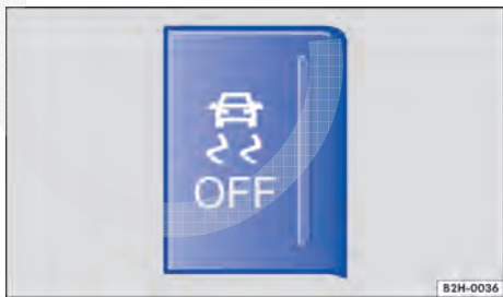
Fig. 106 No console central: botão para desligar e ligar ESC manualmente.
