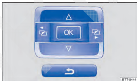
Fig. 15 Veículos com volante multifunções: botões para comandar os menus no instrumento combinado.
