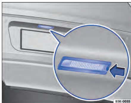
Fig. 174 Na chapa terminal traseira embaixo da tampa do compartimento de carga: lanterna da placa de licença.
