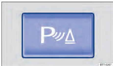
Fig. 113 No console central: botão para ligar e desligar o Park Pilot.
