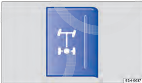
Fig. 112 No console central: botão do bloqueio do diferencial do eixo traseiro.
