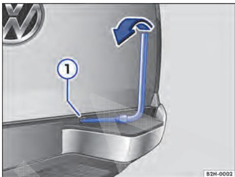
Fig. 151 Girar a roda sobressalente para baixo pelo guincho.
