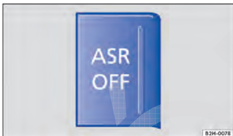
Fig. 105 No console central: botão para desligar e ligar o ASR manualmente.
