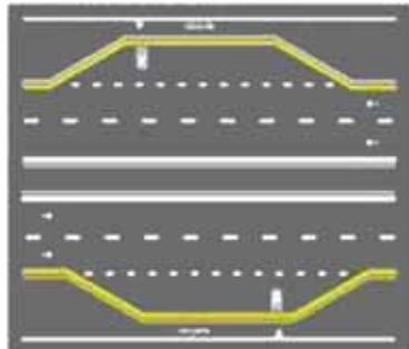
Marca delimitadora para parada de ônibus em avanço de calçada na faixa de estacionamento
