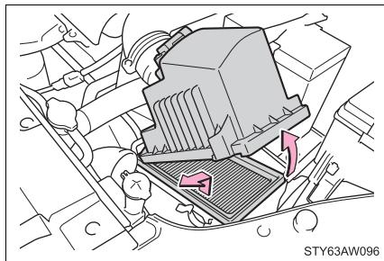
Inspecione a superfície externa do filtro, e substitua-o caso esteja extremamente sujo. Se o filtro estiver apenas um pouco empoeirado, aplique ar comprimido para remover a poeira.
