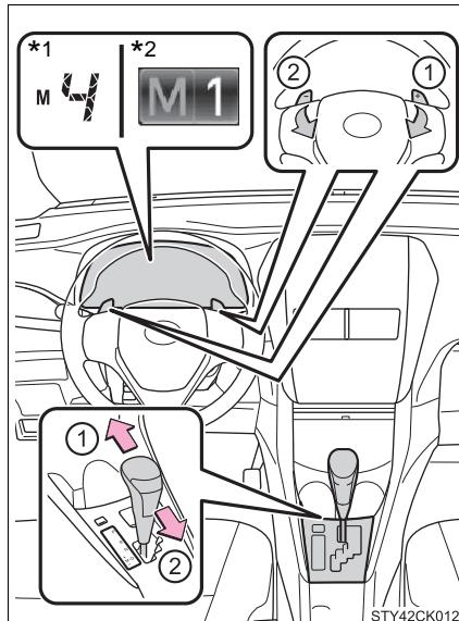
Contudo, mesmo quando na posição M, as faixas de marcha são alteradas automaticamente se a rotação do motor for excessivamente alta ou excessivamente baixa.
