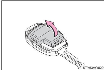
**3** Abra a tampa da caixa usando uma moeda envolvida com fita, e remova a bateria descarregada.
