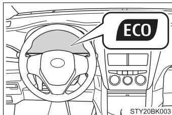
Durante a aceleração em condução ecológica, o indicador de condução Eco acenderá. Quando o pedal do acelerador é pressionado excessivamente, ou quando o veículo é parado, o indicador apaga.
