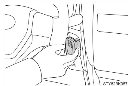
**3** Veículos com computador de bordo monocromático: Pressione o pedal de freio firmemente (transmissão CVT) ou o pedal da embreagem (transmissão manual) e verifique se o indicador da smartkey (verde) acende.
