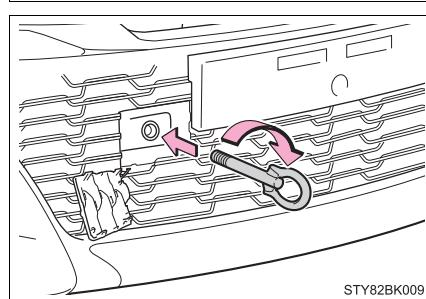
**4** Aperte firmemente o olhal de reboque usando uma chave de roda ou uma barra de metal rígida.
