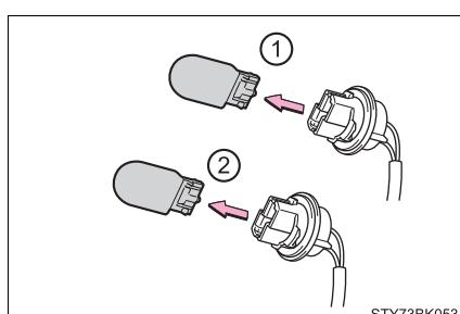
**5** Ao instalar a lâmpada, instale-a conduzindo **4** e **3** com os sentidos invertidos.
