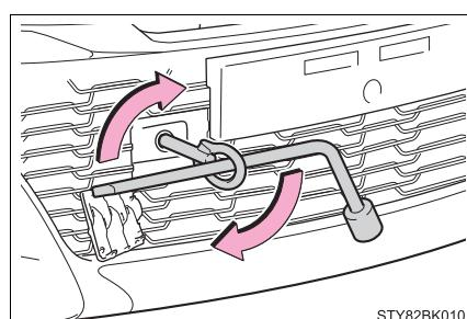
**5** Fixe firmemente os cabos e correntes ao olhal de reboque.
