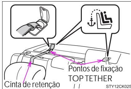
n Instalação da cinta de retenção superior nos pontos de fixação TOP TETHER
