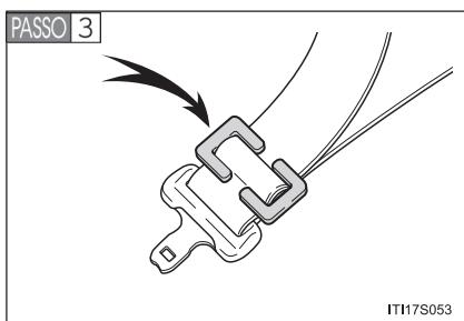
Instale a presilha de travamento próximo à lingueta do cinto de segurança (ombro e quadril) inserindo o cinto nos rebaixos da presilha de travamento. Trave o cinto novamente. Se houver folga no cinto, destrave a fivela e reinstale a presilha de travamento. (→P. 1-1-38)
