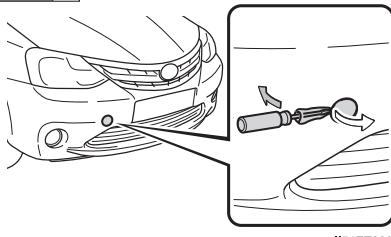
Remova a tampa do olhal usando uma chave de fenda.
