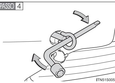
Aperte o olhal de rebocamento firmemente usando uma chave de roda.
