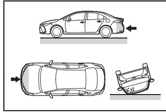
Os airbags de cortina, em geral, não deflagram se o veículo for envolvido em uma colisão frontal ou traseira, se capotar, ou ainda em caso de colisão frontal e/ou lateral em baixa velocidade.
