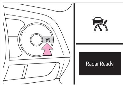
Se o interruptor principal de Controle de Velocidade Adaptativo (ACC) for mantido pressionado por 1,5 segundo ou mais, o sistema ligará no modo de controle de velocidade constante. (→P.256)
