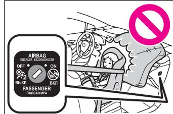
Há uma etiqueta no para-sol do lado do passageiro, indicando que é proibido fixar um dispositivo de retenção para criança no banco do passageiro dianteiro. Detalhes da etiqueta estão descritos na ilustração abaixo.
