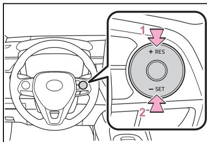
No modo de controle de distância veículo-a-veículo, a velocidade ajustada será aumentada ou reduzida conforme segue:
