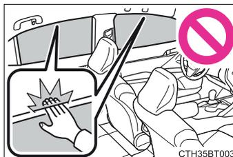
I Ao usar a função de controle remoto ou a chave mecânica e operar os vidros elétricos, opere o vidro elétrico após certificar-se de que não há possibilidade de que qualquer parte do corpo de algum passageiro fique presa no vidro. Além disso, não permita que uma criança acione o vidro com a função de controle remoto ou a chave mecânica. É possível que uma criança ou outros passageiros fiquem presos no vidro elétrico.
