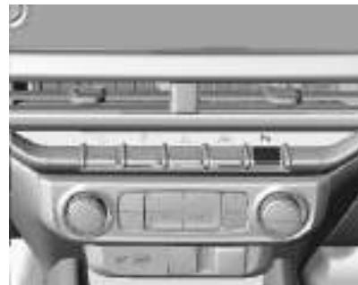
O botão **P** do painel de instrumentos é usado para ligar ou desligar o Assistente de estacionamento dianteiro e traseiro. O indicador LED próximo ao botão acende quando as funções estiverem ligadas e apaga quando as funções estiverem desligadas. Deslique o assistente de estacionamento quando estiver com um reboque.
