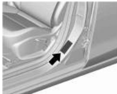
A etiqueta de pressão dos pneus está na coluna da porta dianteira esquerda.
