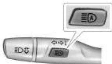
Para ativar o sistema IntelliBeam, pressione (A) na alavanca da seta quando estiver escuro do lado de fora e o controle das luzes externas estiver em AUTO ou em .
