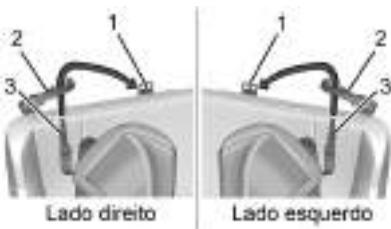
5. Certifique-se de que o gancho do cabo superior do dispositivo de retenção para crianças esteja completamente fechado e preso no ponto de ancoragem do cabo superior.
