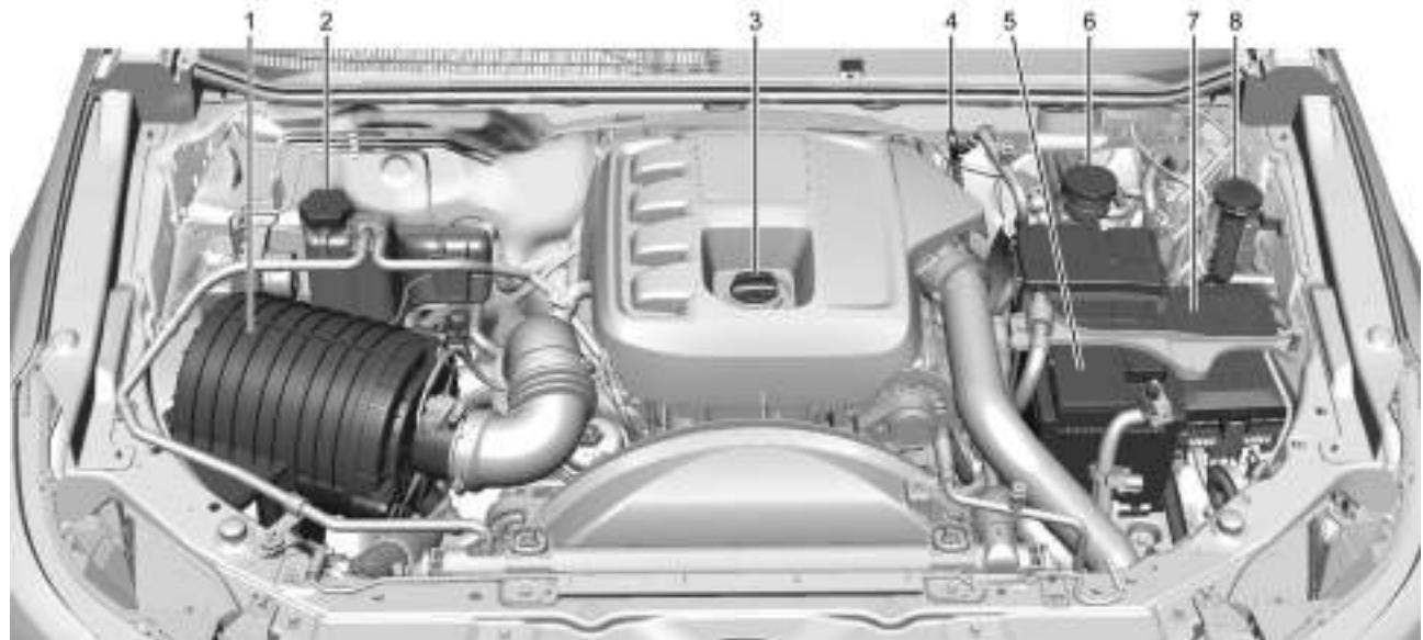
1. Conjunto do filtro de ar do motor/elemento. Consulte "Filtro de ar do motor/elemento".
