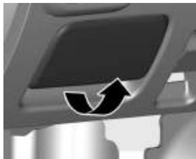
Remova a tampa do painel de instrumentos na direção da seta.
