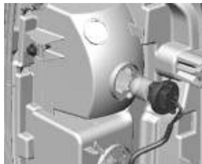
5. Remova o suporte da lâmpada. Pressione levemente a lâmpada no soquete, gire no sentido anti-horário e remova a lâmpada.
