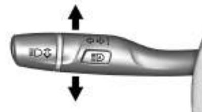
Mova a alavanca totalmente para cima ou para baixo para sinalizar uma alteração de direção.
