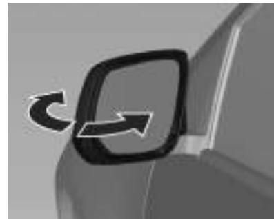
Dobre os espelhos manualmente para dentro em direção ao veículo para evitar danos ao utilizar uma lavadora automática de carros. Empurre o espelho para fora para retorná-lo à sua posição original.
