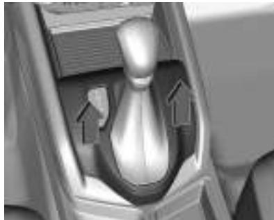
2. Pressione a alavanca seletora do console central na parte de trás para liberá-la, sobre para cima e gire-a para a esquerda.
