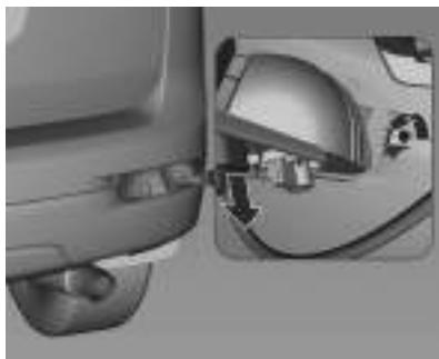
1. Atrás do para-choque traseiro, desparafuse o parafuso para remover o conjunto das luzes do para-choque e desconecte o conector elétrico.
