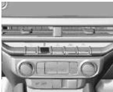
O controle de tração pode ser desligado quando é necessária a derrapagem da roda de tração pressionando o botão
