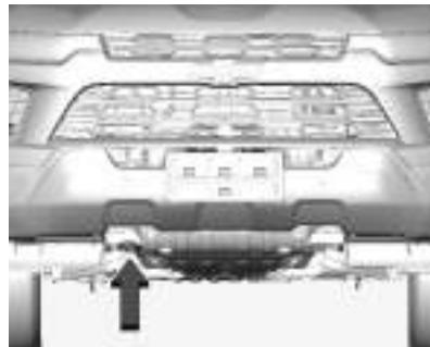
O gancho de reboque se localiza na parte dianteira do veículo sob o para-choque.
