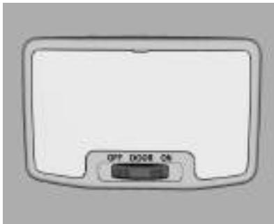
As luzes de cortesia acendem quando alguma porta é aberta, é pressionado no transmissor RKE ou quando a ignição é desligada.
