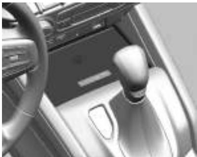
A ignição deve estar ligada em Ligado/operação, ACC/ACESSÓRIO ou a Energia estendida para acessórios (RAP) deve estar ativada. O recurso de carregamento sem fio pode não indicar corretamente o carregamento quando o veículo estiver em RAP. Consulte "Energia estendida para acessórios" na seção *Partida do Motor* ▷ 165.
