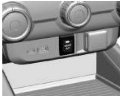
Se equipado, o sistema de ar-condicionado traseiro é operado com o botão **REAR A/C**.
