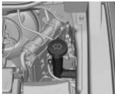
Abra a tampa com o símbolo de lavador. Complete o tanque com fluido do lavador.
