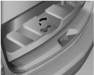
3. Girar a tampa de acesso ao pneu reserva no sentido anti-horário para remover. Levantar a aba do tapete para acessar o encaixe para o guincho.
