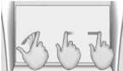
A função Passar ou deslizar é usada para percorrer uma lista, aplicar panorâmica no mapa ou alterar exibições de página. Faça isso colocando um dedo no visor e movendo-o rapidamente para cima e para baixo ou para a direita e para a esquerda.
