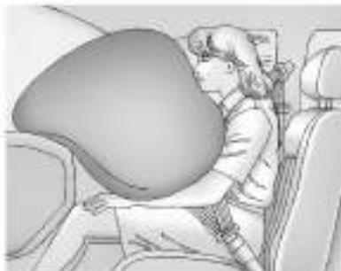
O airbag do passageiro dianteiro está no painel de instrumentos do lado do passageiro.
