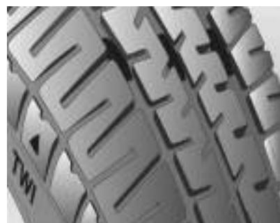
Os pneus devem ser substituídos quando a profundidade da banda de rodagem estiver desgastada até próximo de 1,6 mm. A figura mostra onde pode ser encontrada a profundidade da banda de rodagem.
