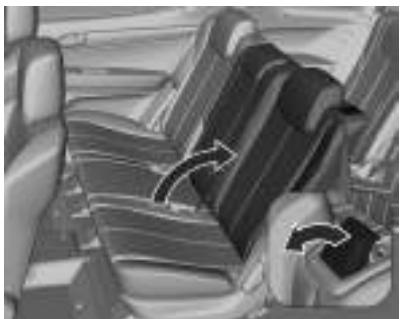
Puxe a alavanca próxima ao apoio de cabeça para cima e levante o encosto do banco até que ele encaixe. Assegure-se de que o banco esteja encaixado na posição.
