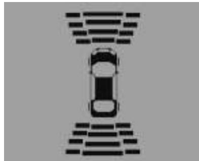
O painel de instrumentos pode ter um visor do assistente de estacionamento com barras que exibem a "distância para o objeto" e as informações de localização de objeto para o Sistema do assistente de estacionamento. À medida que o objeto se aproxima, mais barras se acendem.
