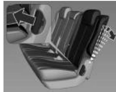
Puxe a alavanca, ajuste a inclinação, solte a alavanca e deixe o encosto encaixar.
