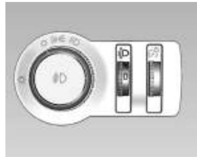
Para adaptar o alcance do farol à carga do veículo e evitar ofuscamento: gire o botão para a posição necessária.
