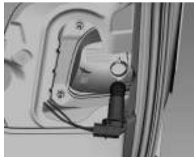
4. Remova a lâmpada do suporte. Empurre a lâmpada no soquete levemente para inseri-la.
