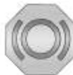
A tampa do reservatório do fluido da embreagem hidráulica/freio possui esse símbolo. O reservatório de fluido do freio/embreagem comum é abastecido com fluido de freio DOT 4LV, conforme indicado na tampa do reservatório. Consulte *Vista geral do compartimento do motor* ▷ 221 para ver o local do reservatório.
