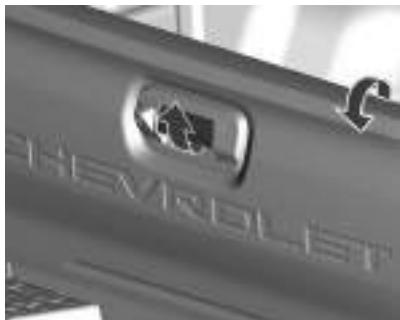
Para abrir, puxe a maçaneta central e abaixe a tampa do compartimento de carga. Para fechar, levante a tampa do compartimento de carga e pressione as extremidades superiores até ouvir um ruído de travamento.
