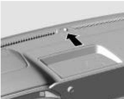
O LED de Status está integrado ao sensor na parte superior do painel de instrumentos.
