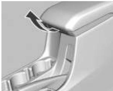
Pressione a trava e levante a tampa do apoio de braço.
