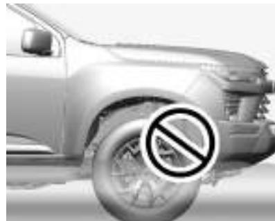
Dirija em baixa velocidade através de qualquer área alagada e certifique-se de que o limite de água não exceda a altura do centro da roda.
