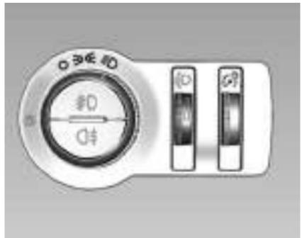
Este recurso ajusta a luminosidade de todos os controles iluminados. O controle de iluminação do painel de instrumentos está próximo do controle das luzes externas.
