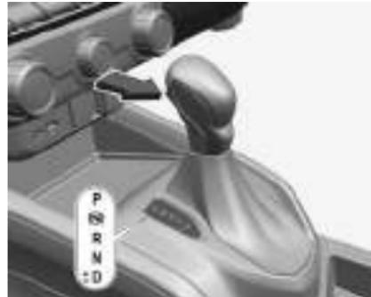
**P:** posição estacionamento, as rodas estão travadas, só engate quando o veículo estiver parado e o freio de estacionamento aplicado.
