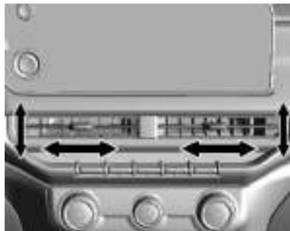
Empurre a manopla de ajuste para a direita e a esquerda para fechar o difusor ou ajustar o volume de ar.
