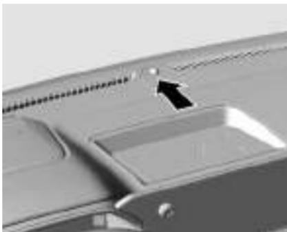
O veículo possui um sensor de iluminação na parte superior do painel de instrumentos que controla o sistema automático dos faróis. Não obstrua esse sensor, do contrário, os faróis poderão acender mesmo que não sejam necessários.
