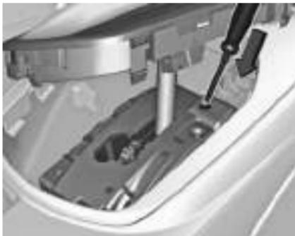
3. Insira uma chave de fenda na abertura até o ponto onde ela alcançar e move a alavanca seletora da posição P. Se P for engatada de novo, a alavanca seletora ficará bloqueada na posição novamente. Dirija até uma Concessionária ou Oficina Autorizada Chevrolet assim que possível para verificar e consertar.
