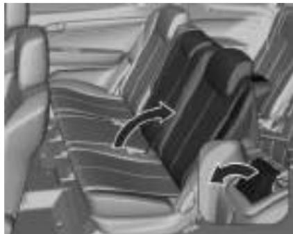
Puxe a alavanca próxima ao apoio de cabeça para cima e levante o encosto do banco até que ele encaixe. Assegure-se de que o banco esteja encaixado na posição.
