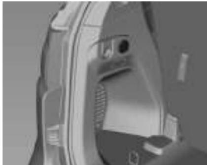
Apenas para Trailblazer, há uma tomada elétrica de 12 V localizada no lado esquerdo do compartimento de carga.
