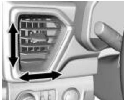
Empurre a manopla de ajuste para a direita e a esquerda para fechar o difusor ou ajustar o volume de ar.
