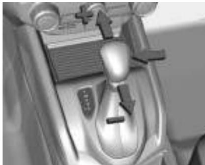
Mova a alavanca seletora da posição D para a esquerda para selecionar o modo manual.
