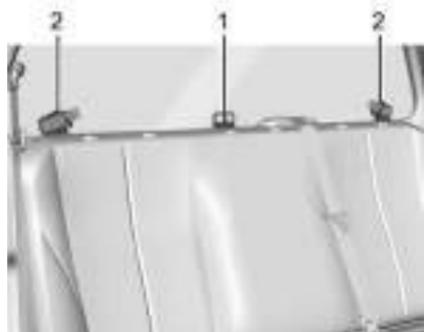
O cabo superior é encaminhado através de anéis (2) para as ancoragens superiores (1). Certifique-se de ler as instruções abaixo para instalar corretamente um dispositivo de retenção para crianças usando esses anéis e ancoragens.
