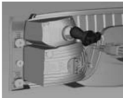
5. Remova o suporte da lâmpada. Pressione ligeiramente a lâmpada no soquete, gire no sentido anti-horário e remova a lâmpada.
