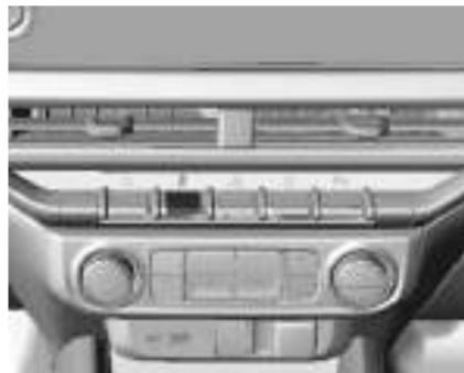
O controle de tração pode ser desligado quando é necessária a derrapagem da roda de tração pressionando o botão
