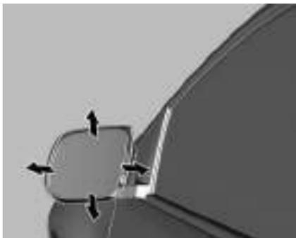
Ajuste manualmente inclinando-o para uma posição adequada.
