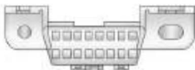
O DLC está em baixo do painel de instrumentos, no lado esquerdo do volante. Dispositivos de conexão que não são usados para realizar um teste de manutenção/inspeção de emissões ou para reparar o veículo podem afetar o funcionamento do veículo. Consulte Equipamento elétrico adicional no Manual do Proprietário. Consulte sua concessionária se precisar de assistência.
