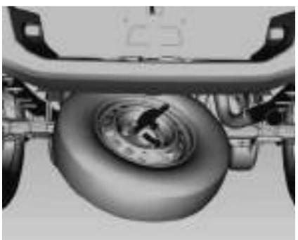
4. Incline o retentor quando o pneu estiver abaixado e deslize-o para cima pelo cabo de modo que possa ser puxado através da abertura da roda.
