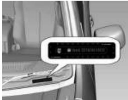
O Número de identificação do veículo (VIN) está embutido no painel de instrumentos, visível pelo para-brisa.
