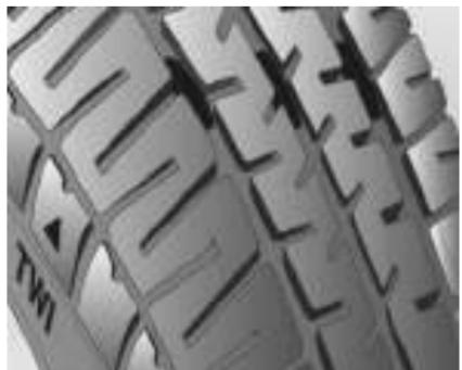
Os pneus devem ser substituídos quando a profundidade da banda de rodagem estiver desgastada até próximo de 1,6 mm. A figura mostra onde pode ser encontrada a profundidade da banda de rodagem.
