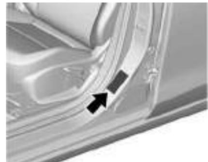
A etiqueta de pressão dos pneus está na coluna da porta dianteira esquerda.
