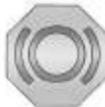
A tampa do reservatório do fluido da embreagem hidráulica/freio possui esse símbolo. O reservatório de fluido do freio/embreagem comum é abastecido com fluido de freio DOT 4LV, conforme indicado na tampa do reservatório. Consulte *Vista geral do compartimento do motor* ▷ 219 para ver o local do reservatório.
