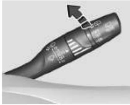
O limpador do vidro traseiro só opera com a ignição ligada ou modo de acessórios.
