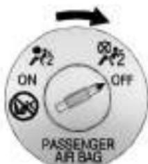
Se o painel de instrumentos possuir o interruptor mostrado na figura, então o veículo possui um interruptor de ativação-
