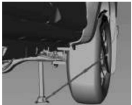
Se o pneu furado estiver na parte traseira, posicione o macaco sob o eixo traseiro o mais próximo possível do amortecedor.
