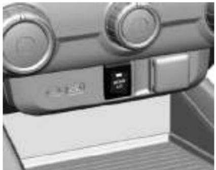
Se equipado, o sistema de ar-condicionado traseiro é operado com o botão **REAR A/C**.
