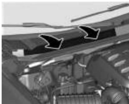
A entrada de ar em frente ao para-brisa no compartimento do motor deve estar desobstruída para permitir a entrada de ar. Remova folhas, sujeira ou neve.
