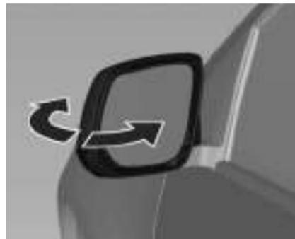
Dobre os espelhos manualmente para dentro em direção ao veículo para evitar danos ao utilizar uma lavadora automática de carros. Empurre o espelho para fora para retorná-lo à sua posição original.
