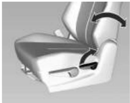
Puxe a alavanca, ajuste a inclinação e solte a alavanca. O banco deverá travar na posição. Tente mover o banco para frente e para trás para certificar-se de que o banco esteja travado na posição.
