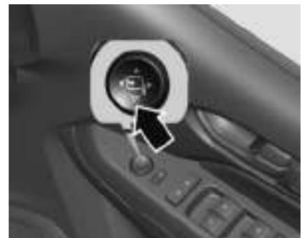
Pressione seletor (interruptor L / R) para a posição central, depois pressione o interruptor de quatro posições para dobrar os espelho eletricamente. Pressione novamente para desdobrar.
