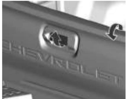
Para abrir, puxe a maçaneta central e abaixe a tampa do compartimento de carga. Para fechar, levante a tampa do compartimento de carga e pressione as extremidades superiores até ouvir um ruído de travamento.
