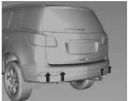
O assistente de estacionamento facilita o estacionamento medindo a distância entre o veículo e os obstáculos e fornecendo sinais sonoros. É o motorista, no entanto, que tem total responsabilidade pela manobra de estacionamento.
