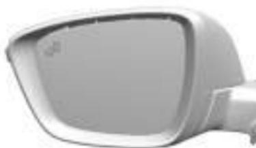
Quando a velocidade do veículo está acima de 10 km/h, o sistema de alerta de ponto cego lateral é ativado. Quando a velocidade do veículo for superior a 140 km/h, o sistema será desligado e a luz indicadora dos espelhos externos esquerdo e direito ficará esmaecida.
