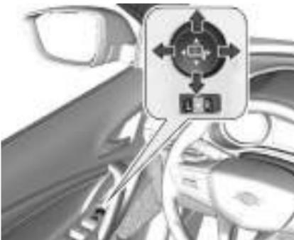
O controle para os espelhos elétricos se localiza no acabamento da porta do lado do motorista. Selecione o espelho externo esquerdo ou direito com o interruptor do seletor e ajuste-o com o interruptor de quatro posições.
