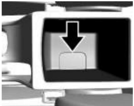
1. Coloque a chave ou o transmissor dentro do apoio de braço como mostrado na figura.
