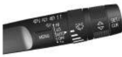
Com a ignição ligada ou em ACC/ACCESSORY, mova a alavanca do limpador do para-brisa para selecionar a velocidade do limpador.
