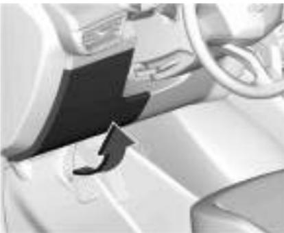
A caixa de fusíveis do painel de instrumentos está localizada na parte inferior do painel de instrumentos do lado do motorista.
