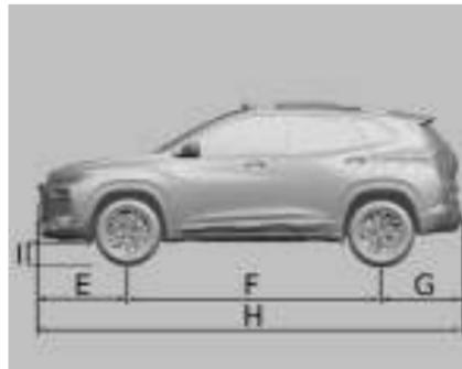
E. Distância entre o centro da roda dianteira e o para-choque dianteiro – 878 mm
