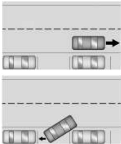
Depois de passar completamente da vaga, o APA instruirá o motorista a parar o veículo e mudar para R (ré) para engatar a direção automática. O volante vibrará brevemente como um lembrete para que o motorista retire
