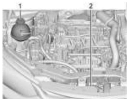
Mostrado reservatório de expansão do líquido de arrefecimento do motor turbo, outros similares
