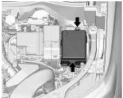
A caixa de fusíveis está na parte dianteira esquerda do compartimento do motor.
