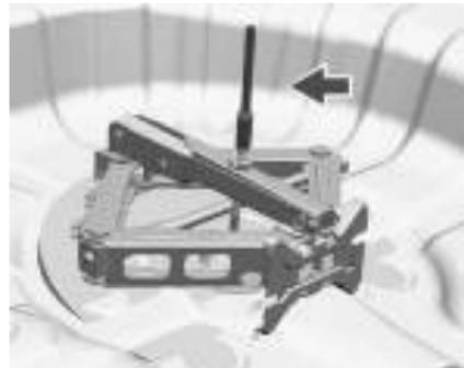
4. Instale o parafuso de extensão antes de colocar o pneu de tamanho normal danificado na cavidade do pneu reserva.
