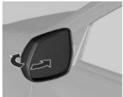
Para segurança do pedestre, os espelhos externos sairão da posição de montagem normal caso alguém colida com eles com força suficiente para isso. Reposicione o espelho ao aplicar uma leve pressão na caixa do espelho. Essa função é útil também para reduzir a largura total do veículo e evitar danos quando o veículo estiver estacionado. Coloque o espelho de volta na posição funcional antes de dirigir.
