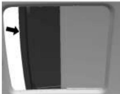
A sujeira e detritos podem se acumular na vedação do teto solar ou no trilho. Isto poderá causar um problema no funcionamento ou ruído no teto solar. Isto também poderá obstruir o sistema de drenagem de água. Abra periodicamente o teto solar e remova qualquer obstáculo ou detrito solto. Limpe a vedação do teto solar e a área de vedação usando um pano limpo, sabão suave e água. Não remova a graxa do teto solar.
