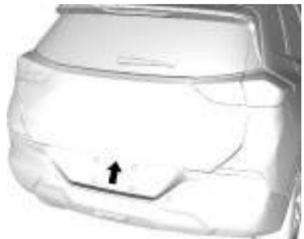
Para abrir a tampa do porta-malas, o veículo deve estar desligado ou parado com a alavanca de mudança em P (Estacionamento), se equipado.
