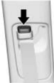
Pressione o botão de liberação e mova o ajustador de altura para a posição desejada. O regulador pode ser movido para cima empurrando para cima o controle deslizante/acabamento. Depois de regulado na posição correta, tente mover o regulador para baixo sem pressionar o botão de destravamento para certificar-se de que esteja travado na posição.
