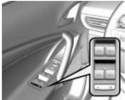
Pressione o interruptor para desativar o interruptor dos vidros elétricos traseiros. Para ativar, pressione novamente.
