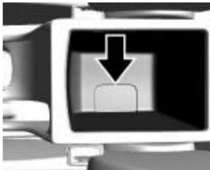
Coloque a chave não remota ou a chave eletrônica no porta-objetos do console central embaixo do apoio de braço. A posição correta é mostrada na figura.
