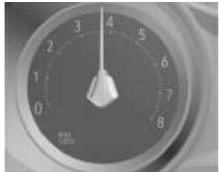
O tacômetro exibe a velocidade do motor em rotações por minuto (rpm).
