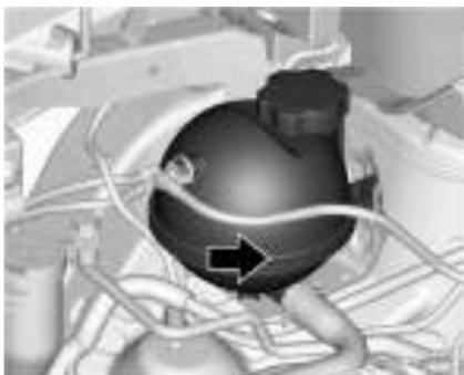
O reservatório de expansão de líquido de arrefecimento fica localizado no compartimento do motor no lado do passageiro do veículo. Consulte *Vista geral do compartimento do motor (Injeção direta)* ▷ 192.
