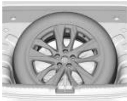
5. Coloque o pneu murcho no porta-malas. Coloque o pneu furado no assoalho traseiro antes.
