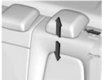
A altura do apoio de cabeça pode ser ajustada. Puxe o apoio de cabeça para levantá-lo. Tente mover o apoio de cabeça para se certificar de que ele está travado na posição.
