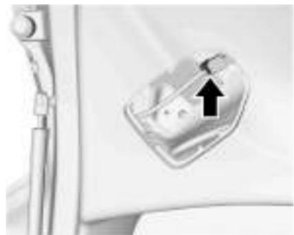
4. Solte o conjunto da lanterna do conector e retire o conjunto da lanterna traseira da tampa do porta-malas.
