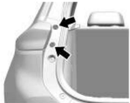
2. Remova os dois parafusos que prendem o conjunto da lanterna traseira na carroceria do veículo.
