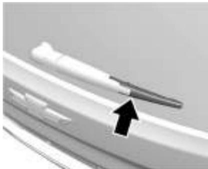
Levante a alavanca do limpador. Pressione a palheta do limpador, ligeiramente inclinada para o braço do limpador, para baixo até que ela desencaixe.
