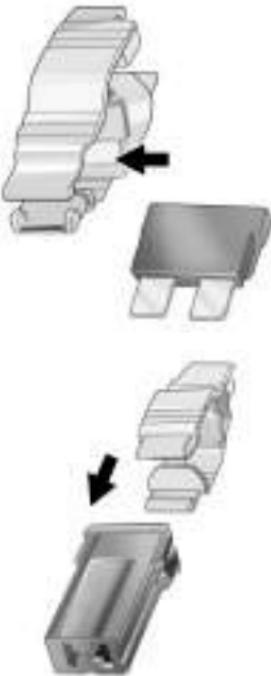
Coloque o extrator de fusível sobre os vários tipos de fusíveis pela parte superior ou pela lateral e remova o fusível.
