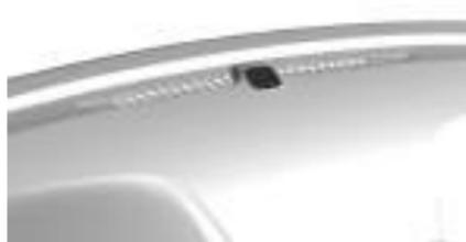
Há um sensor de iluminação na parte superior do painel de instrumentos. Não cubra o sensor. O sistema pode ligar os faróis quando estiver dirigindo em um estacionamento coberto ou túnel.
