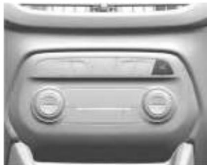
Pressione **P<sup>APA</sup>** para ativar o sistema para procurar uma vaga de estacionamento grande o suficiente e dentro de 1,5 m (5 pés) do veículo. A velocidade do veículo deve estar abaixo de 30 km/h (18 mph).
