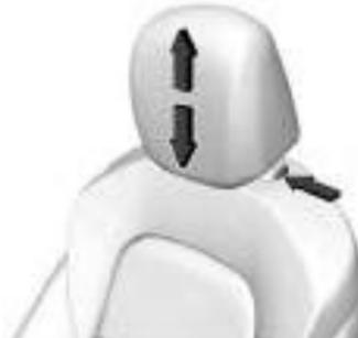
Puxe o apoio de cabeça para levantá-lo. Tente mover o apoio de cabeça para se certificar de que ele está travado na posição.
