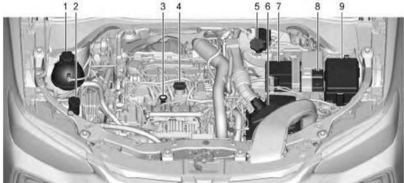
1. Reservatório do líquido de arrefecimento do motor.
