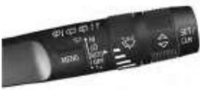
Com a ignição ligada ou em ACC/ACCESSORY, mova a alavanca do limpador do para-brisa para selecionar a velocidade do limpador.
