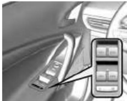
Pressione o interruptor para desativar o interruptor dos vidros elétricos traseiros. Para ativar, pressione novamente.
