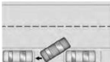
O APA instruirá o veículo a parar quando uma vaga no tamanho adequado for encontrada. Siga as instruções exibidas. Quando instruído, mude para R (Ré) para engatar a direção automática. O volante vibrará brevemente como um lembrete para que o motorista retire as mãos de cima dele. Verifique o entorno e continue a frenagem ou a aceleração conforme necessário e esteja preparado para parar para evitar veículos, pedestres ou objetos.
