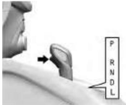
**P:** Esta posição trava as rodas motrizes. Use P (Estacionamento) ao dar partida no motor, pois o veículo não pode se mover facilmente.
