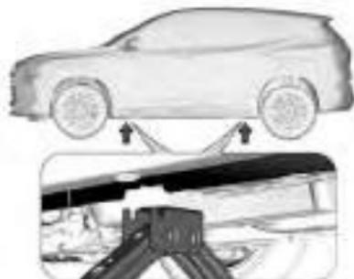
3. Ajuste o macaco até a altura necessária. Posicione-o diretamente sob o ponto de levantamento para evitar que escorregue.
