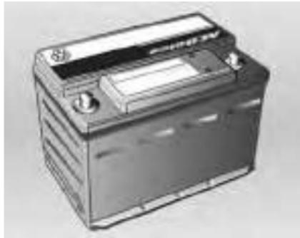
A bateria ACDELCO que equipa o seu veículo dispensa manutenção periódica. Se o veículo não for usado durante 30 dias ou mais, desconecte o cabo do pólo negativo da bateria para não descarregá-la.
