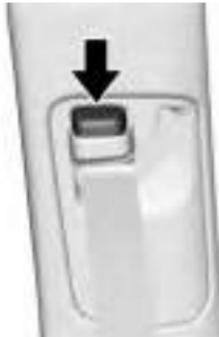
Pressione o botão de liberação e move o ajustador de altura para a posição desejada. O regulador pode ser movido para cima empurrando para cima o controle deslizante/ acabamento. Depois de regulado na posição correta, tente mover o regulador para baixo sem pressionar o botão de destravamento para certificar-se de que esteja travado na posição.
