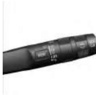
Pressione MENU para alternar entre os menus principais ou voltar de um submenu para o menu de nível superior seguinte.
