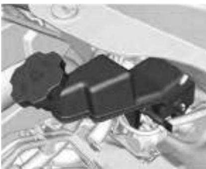
O nível do fluido de freio precisa estar entre as marcas **MIN** e **MAX**.
