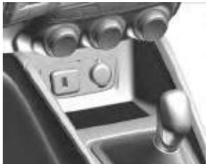
A ignição deve estar ligada em Ligado/operação, ACC/ACESSÓRIO ou a Energia estendida para acessórios (RAP) deve estar ativada. A função de carregamento sem fio pode não indicar corretamente o carregamento quando o veículo estiver em RAP. Consulte *Energia estendida para acessórios (RAP)* ▷ 130.
