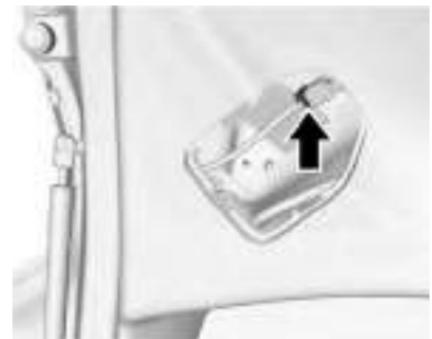
4. Solte o conjunto da lanterna do conector e retire o conjunto da lanterna traseira da tampa do porta-malas.
