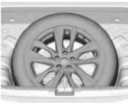
5. Coloque o pneu murcho no porta-malas. Coloque o pneu furado no assoalho traseiro antes.
