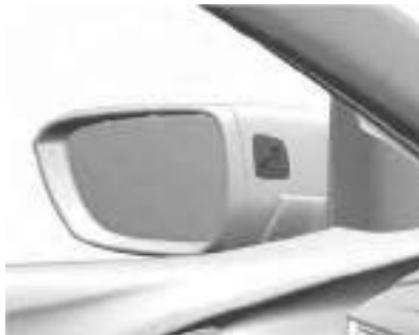
Quando a velocidade do veículo está acima de 10 km/h, o sistema de alerta de ponto cego lateral é ativado. Quando a velocidade do veículo for superior a 140 km/h, o sistema será desligado e a luz indicadora dos espelhos externos esquerdo e direito ficará esmaecida. Nesse momento, se a velocidade do veículo for reduzida, a luz indicadora do espelho desligará. Se for detectado um veículo no ponto cego nesse momento, a luz indicadora do espelho retrovisor correspondente acenderá.
