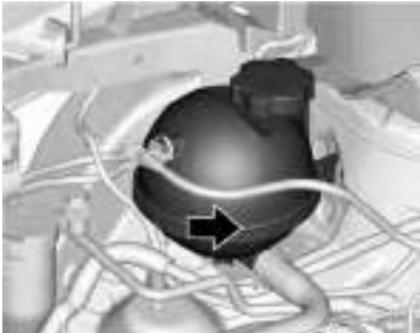
O reservatório de expansão de líquido de arrefecimento fica localizado no compartimento do motor no lado do passageiro do veículo. Consulte *Vista geral do compartimento do motor* ▷ 163 *Vista geral do compartimento do motor (Injeção direta)* ▷ 165.
