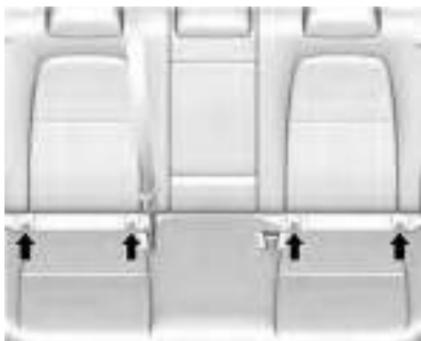
Este veículo é equipado com os suportes de montagem ISOFIX para instalação do dispositivo de retenção para crianças.
