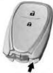
2. Separe as duas metades do transmissor usando uma ferramenta chata inserida na área próxima à fenda da chave.
