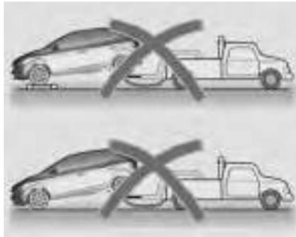
A rebocagem com duas rodas fora do solo não é adequada para este veículo.
