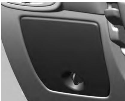
A caixa de fusíveis está localizada no lado esquerdo do painel de instrumentos.
