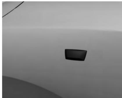
1. Empurre a luz na direção da parte dianteira do veículo e remova-a.
