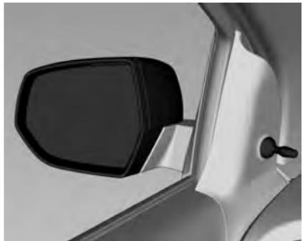
Ajuste o espelho externo manualmente utilizando a alavanca.
