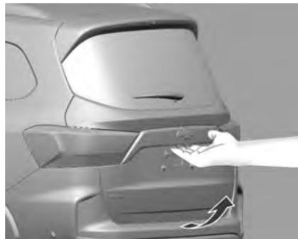
Após destravar, pressione o interruptor sob a maçaneta e abra a tampa do porta-malas.
