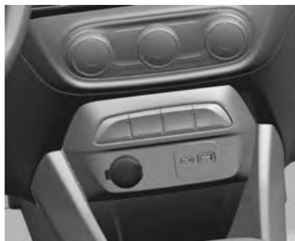
As tomadas elétricas acessórias podem ser usadas para conectar equipamentos elétricos, como um celular, carregadores de GPS ou qualquer outro dispositivo de 12 V que não exceda 120 W.
