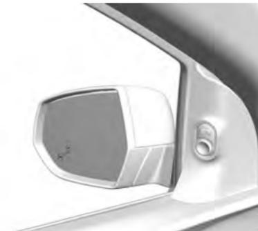
Quando a velocidade do veículo está acima de 11 km/h, o sistema de alerta de ponto cego lateral é ativado. Quando a velocidade do veículo for superior a 140 km/h, o sistema será desligado e a luz indicadora dos espelhos externos esquerdo e direito ficará esmaecida. Nesse momento, se a velocidade do veículo for reduzida, a luz indicadora do espelho desligará. Se for detectado um veículo no ponto cego nesse momento, a luz indicadora do espelho retrovisor correspondente acenderá.
