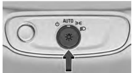
Quando a função de iluminação automática **AUTO** for ligada, o sistema liga automaticamente os faróis dianteiros e as lanternas traseiras, dependendo das condições de iluminação externa.
