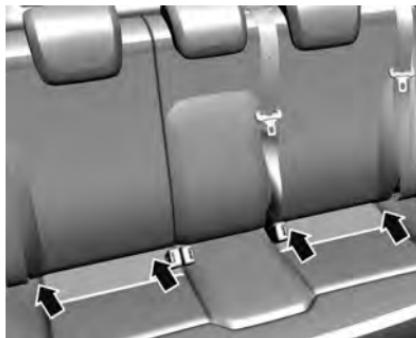
Para instalar um dispositivo de retenção para crianças equipado ISOFIX com pontos de ancoragem inferiores, siga as instruções fornecidas com o dispositivo de retenção para crianças.
