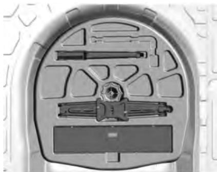
O macaco e as ferramentas são armazenadas em um encaixe no compartimento de carga, abaixo da cobertura do assoalho.
