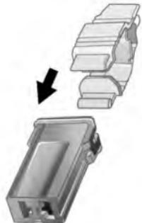
Coloque o extrator de fusível sobre os vários tipos de fusíveis pela parte superior ou pela lateral e remova o fusível.
