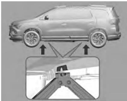
4. Ajuste o macaco até a altura necessária. Posicione-o diretamente sob o ponto de levantamento para evitar que escorregue.
