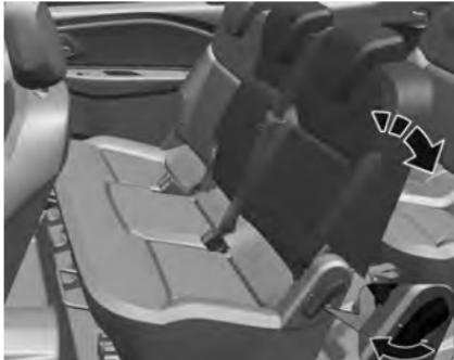
Puxe a alavanca para frente, ajuste a inclinação na posição desejada e solte a alavanca. Deixe o banco engatar de forma audível.
