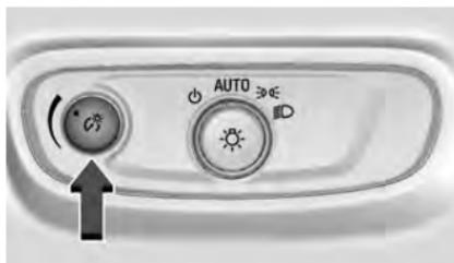
Este recurso ajusta a luminosidade de todos os controle iluminados. O controle de iluminação do painel de instrumentos está próximo do controle das luzes externas.
