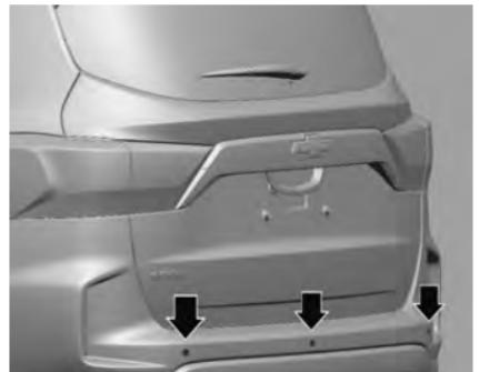
1. Se equipado, o assistente de estacionamento (RPA) usa sensores no para-choque traseiro para auxiliar no estacionamento e evitar objetos durante a ré. Opera em velocidades inferiores a 11 km/h. O RPA pode exibir um triângulo de segurança na tela da Câmera de ré (se equipado), indicando quando um objeto é detectado pelo assistente de estacionamento traseiro (RPA). Além disso, podem ocorrer bipes de acordo com a aproximação ao objeto.
