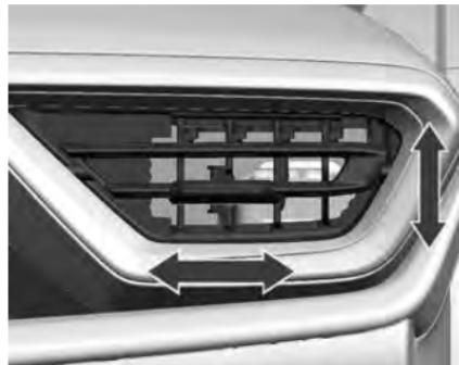
Para abrir os difusores laterais, vire as aletas para cima e a roda do ajustador para a esquerda e a direita até que a direção desejada seja atingida.
