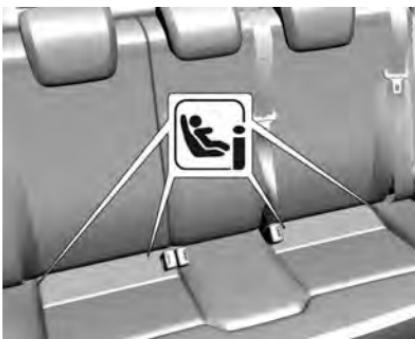
2. Localize as duas posições de ancoragem inferiores. A localização de cada fixação inferior é identificada por uma marcação circular na porção traseira da almofada do banco.
