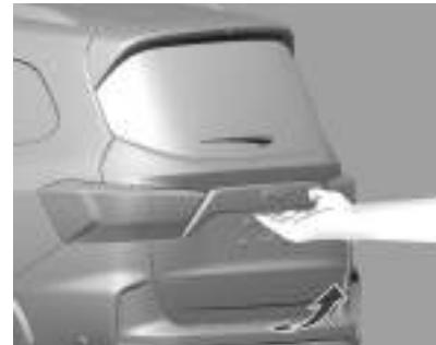
Após destravar, pressione o interruptor sob a maçaneta e abra a tampa do porta-malas.
