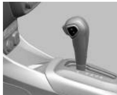
Mova a alavanca seletora para a posição **M**. Pressione o botão de troca de marcha localizado na alavanca seletora.
