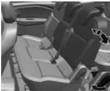
Puxe a alavanca para frente, ajuste a inclinação na posição desejada e solte a alavanca. Deixe o banco engatar de forma audível.
