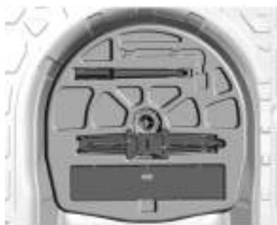
O macaco e as ferramentas são armazenadas em um encaixe no compartimento de carga, abaixo da cobertura do assoalho.
