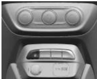
Se equipado, o LDW pode ajudar a evitar colisões resultantes de saídas de pista não intencionais. Ele pode fornecer um alerta se o veículo estiver cruzando a faixa sem usar as setas. O LDW usa a câmera para detectar as marcações da faixa em velocidades de 56 km/h (35 mph) ou superiores.
