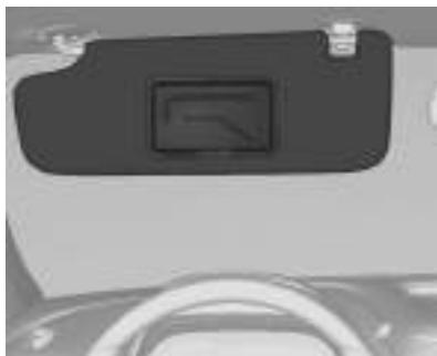
Os para-sóis têm espelhos integrados (se equipado) e podem ser baixado ou girados para o lado, para evitar o ofuscamento.
