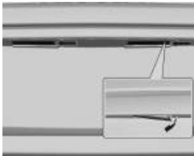
1. Alavanque o soquete com uma ferramenta adequada e remova-o para baixo, tomando cuidado para não puxar o cabo.
