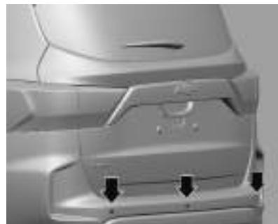
1. Se equipado, o assistente de estacionamento (RPA) usa sensores no para-choque traseiro para auxiliar no estacionamento e evitar objetos durante a ré. Opera em velocidades inferiores a 11 km/h. O RPA pode exibir um triângulo de segurança na tela da Câmera de ré (se equipado), indicando quando um objeto é detectado pelo assistente de estacionamento traseiro (RPA). Além disso, podem ocorrer bipes de acordo com a aproximação ao objeto.
