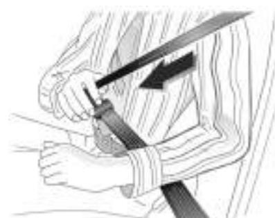
Puxe o cinto, conduza-o pelo corpo, sem torcer, e empurre a lingueta de acoplamento na fivela até que encaixe. Tensione o cinto subabdominal regularmente ao dirigir puxando o cinto diagonal sobre o ombro.
