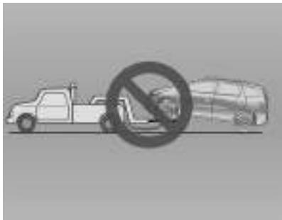
A rebocagem com duas rodas fora do solo não é adequada para este veículo.
