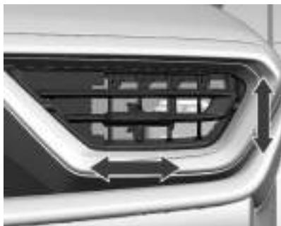
Para abrir os difusores laterais, vire as aletas para cima e a roda do ajustador para a esquerda e a direita até que a direção desejada seja atingida.
