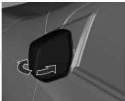
Para segurança do pedestre, os espelhos externos sairão da posição de montagem normal caso alguém colida com eles com força suficiente para isso. Reposite o espelho ao aplicar uma leve pressão na caixa do espelho. Essa função é útil também para reduzir a largura total do veículo e evitar danos quando o veículo estiver estacionado. Coloque o espelho de volta na posição funcional antes de dirigir.
