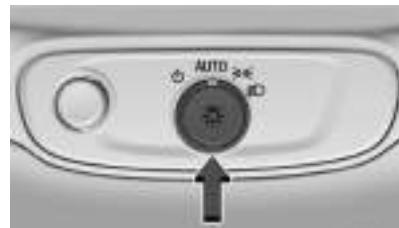
Quando a função de iluminação automática AUTO for ligada, o sistema liga automaticamente os faróis dianteiros e as lanternas traseiras, dependendo das condições de iluminação externa.
