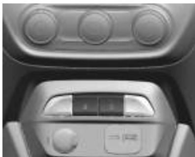
O LED de status é integrado com o botão de travamento central, próximo ao centro do painel de instrumentos.
