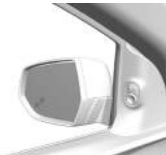
Quando a velocidade do veículo está acima de 11 km/h, o sistema de alerta de ponto cego lateral é ativado. Quando a velocidade do veículo for superior a 140 km/h, o sistema será desligado e a luz indicadora dos espelhos externos esquerdo e direito ficará esmaecida. Nesse momento, se a velocidade do veículo for reduzida, a luz indicadora do espelho desligará. Se for detectado um veículo no ponto cego nesse momento, a luz indicadora do espelho retrovisor correspondente acenderá.
