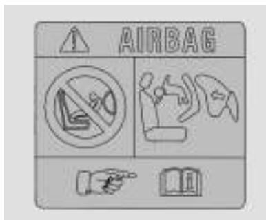
Veículos equipados com "Airbag" podem ser identificados pela palavra "Airbag" na etiqueta autoadesiva do para-sol do lado do passageiro.
