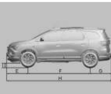
E. Distância entre o centro da roda dianteira e o para-choque dianteiro – 901 mm
