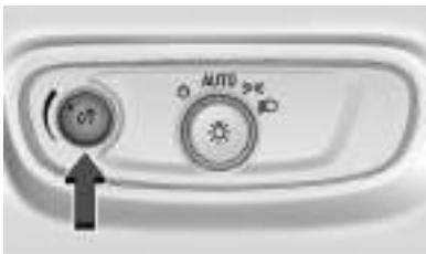
Este recurso ajusta a luminosidade de todos os controle iluminados. O controle de iluminação do painel de instrumentos está próximo do controle das luzes externas.
