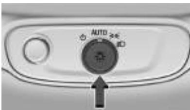
O controle das luzes externas está à esquerda da coluna da direção no painel de instrumentos.
