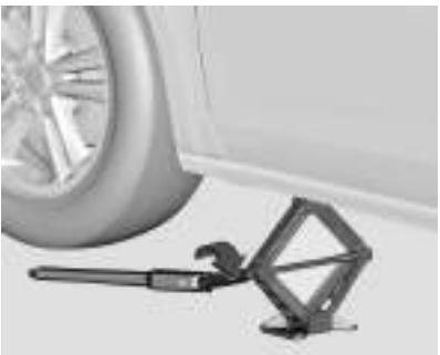
Conecte a chave de roda (C) e, com a alavanca (B) do macaco no alinhamento correto, gire-a até que o pneu se erga do chão.
