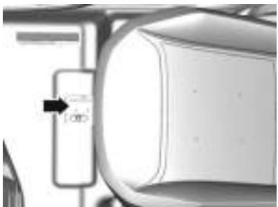
O veículo tem uma localização correta para instalar o extintor de incêndio, abaixo do banco dianteiro do passageiro, sob o carpete do piso. O extintor de incêndio e as presilhas de suporte podem ser adquiridas e instaladas em concessionárias Chevrolet.
