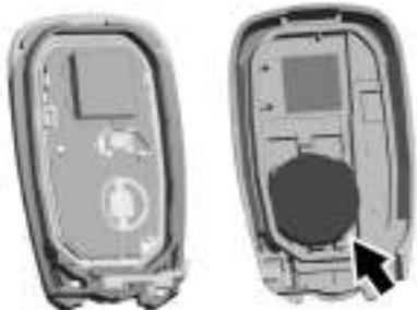
3. Remova a bateria pressionando a bateria e deslizando-a para a parte de baixo do transmissor.
