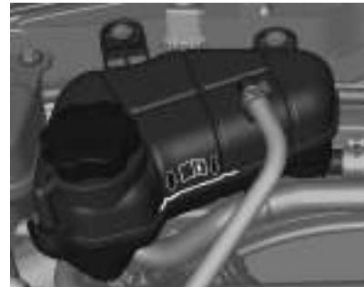
Se o sistema de resfriamento estiver frio, o nível do líquido de arrefecimento deve estar acima da marca de enchimento. Complete se
