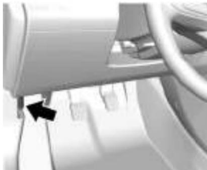
Puxe a alavanca de abertura do capô. A alavanca encontra-se no interior do veículo, à esquerda da coluna de direção.
