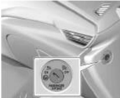
O sistema de airbag do passageiro pode ser desativado a partir de uma trava no painel de instrumentos, visível quando a porta dianteira do passageiro está aberta.
