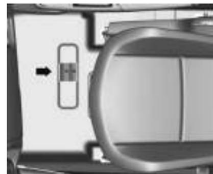
O veículo tem uma localização correta para instalar o extintor de incêndio, abaixo do banco dianteiro do passageiro. O extintor de incêndio e as presilhas de suporte podem ser adquiridas e instaladas nas concessionárias.
