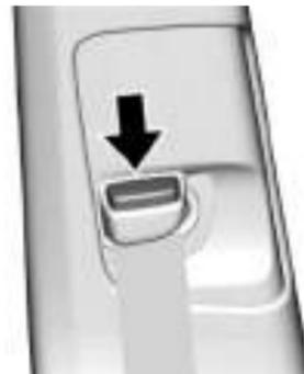
Pressione o botão de liberação e mova o ajustador de altura para a posição desejada. O regulador pode ser movido para cima empurrando para cima o controle deslizante/acabamento. Depois de regulado na posição correta, tente mover o regulador para baixo sem pressionar o botão de destravamento para certificar-se de que esteja travado na posição.
