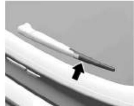
Para veículos hatchback, levante o braço do limpador. Pressione a palheta do limpador, ligeiramente inclinada para o braço do limpador, para baixo até que ela desencaixe.
