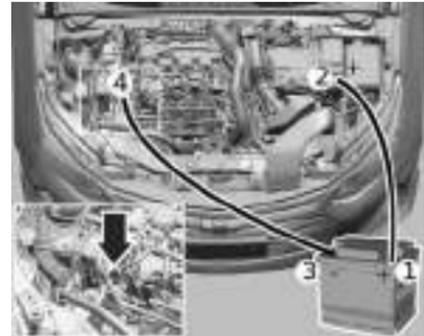
9. Conecte os cabos auxiliares na sequência indicada:
