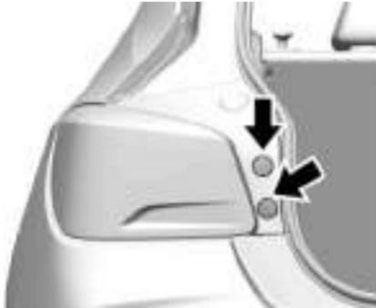
1. Remova e retenha os parafusos acoplado a montagem da lanterna na carroceria do veículo.
