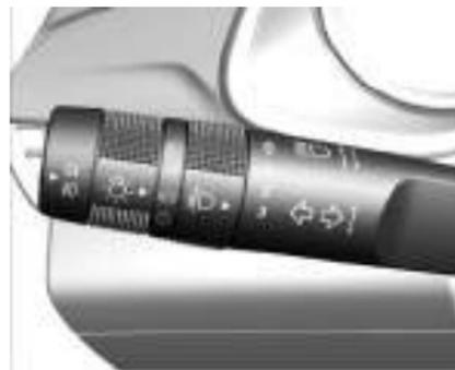
☰● : Com os faróis ligados, empurre a alavanca de seta para a dianteira do veículo e solte-a, para acender os faróis altos. Para retornar para faróis baixos, empurre a alavanca novamente ou puxe-a em sua direção e solte.
