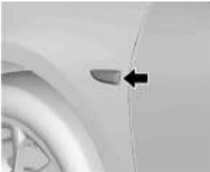
1. Force para fora o alojamento da lâmpada com uma ferramenta adequada, cuidando para não puxar o cabo.
