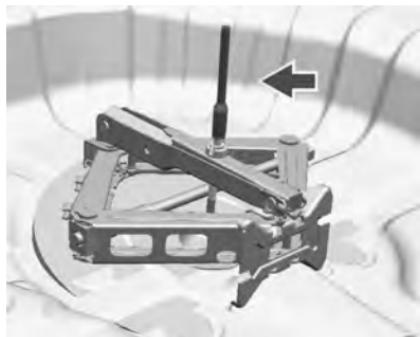
4. Instale o parafuso de extensão antes de colocar o pneu de tamanho normal danificado na cavidade do pneu reserva.
