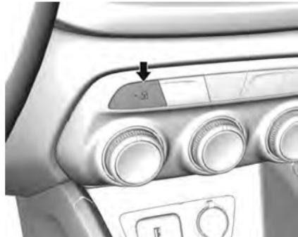
O veículo tem um sistema de alarme antifurto. A luz indicadora, integrada no interruptor das travas elétricas, indica o status do sistema. **acende:** teste, retardo na armação. **pisca lentamente:** sistema está armado.
