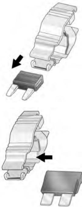
Coloque o extrator de fusível sobre os vários tipos de fusíveis pela parte superior ou pela lateral e remova o fusível.
