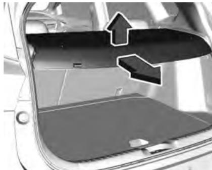
Para remover a cobertura do veículo, solte o cordão e remova a cobertura do encaixe. Para reinstalar, coloque cada extremidade da cobertura nos encaixes e deslize-a até a extremidade do encaixe de ambos os lados. Certifique-se de que os dois lados estejam instalados corretamente de acordo com a figura abaixo. Prenda o cordão na tampa do porta-malas.
