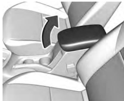
O console central entre os bancos dianteiros tem um compartimento de armazenamento. Pressione o botão para abri-lo.
