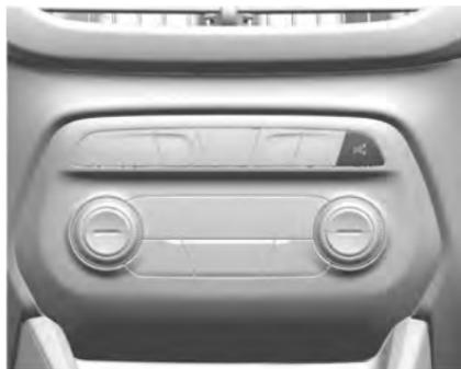
Pressione **P//A** para ativar o sistema para procurar uma vaga de estacionamento que tenha o tamanho adequado e dentro de 1,5 m (5 pés) do veículo. A velocidade do veículo deve estar abaixo de 30 km/h (18 mph).
