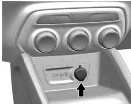
As tomadas elétricas acessórias podem ser usadas para conectar equipamentos elétricos, como um celular, carregadores de GPS ou qualquer outro dispositivo de 12 V que não excede 120 W.
