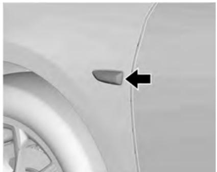
1. Force para fora o alojamento da lâmpada com uma ferramenta adequada, cuidando para não puxar o cabo.
