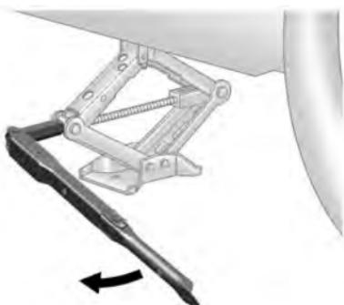
Levante o veículo girando a alavanca do macaco no sentido horário. Erga o veículo do chão o suficiente para que haja espaço para retirar o pneu de estrada do contato com o chão.
