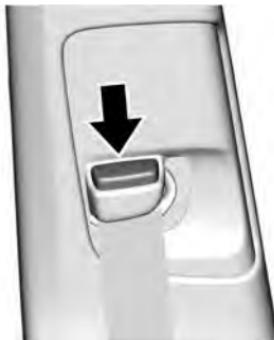
Pressione o botão de liberação e move o ajustador de altura para a posição desejada. O regulador pode ser movido para cima empurrando para cima o controle deslizante/ acabamento. Depois de regulado na posição correta, tente mover o regulador para baixo sem pressionar o botão de destravamento para certificar-se de que esteja travado na posição.
