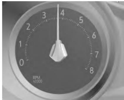
O tacômetro exibe a velocidade do motor em rotações por minuto (rpm).
