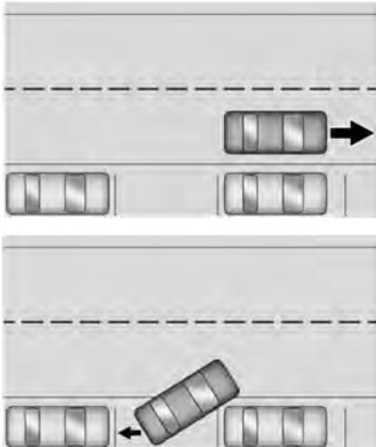
Depois de passar completamente da vaga, o APA instruirá o motorista a parar o veículo e mudar para R (ré) para engatar a direção automática. O volante vibrará brevemente como um lembrete para que o motorista retire as mãos de cima dele. Verifique o entorno e continue a frenagem ou a aceleração conforme necessário e esteja preparado para parar para evitar veículos, pedestres ou objetos.
