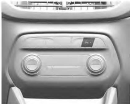
Se equipado, o botão **P//A** é usado para ligar ou desligar o auxiliar de estacionamento dianteiro e traseiro ao mesmo tempo. A luz indicadora próxima ao botão acende quando as funções estão ligadas e apaga quando as funções estão desligadas.
