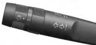
Mova a alavanca totalmente para cima ou para baixo para sinalizar uma alteração de direção.
