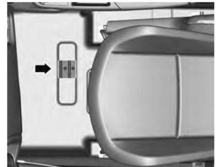
O veículo tem uma localização correta para instalar o extintor de incêndio, abaixo do banco dianteiro do passageiro. O extintor de incêndio e as presilhas de suporte podem ser adquiridas e instaladas nas concessionárias.
