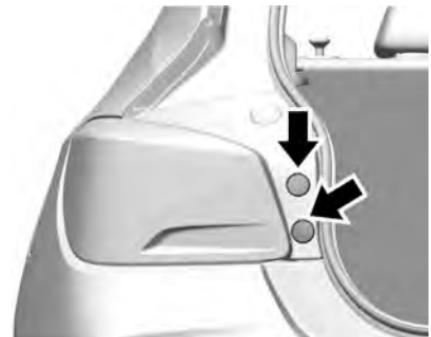
1. Remova e retenha os parafusos acoplando a montagem da lanterna na carroceria do veículo.
