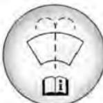
Abra a tampa com o símbolo de lavador. Complete o tanque com fluido do lavador. Consulte *Vista geral do compartimento do motor (Motor 1.0L L3 turbo)* ▷ 180 *Vista geral do compartimento do motor (Motor 1.0L L3)* ▷ 182 para ver o local do reservatório.
