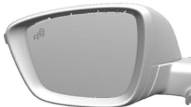
Quando a velocidade do veículo está acima de 10 km/h, o sistema de alerta de ponto cego lateral é ativado. Quando a velocidade do veículo for superior a 140 km/h, o sistema será desligado e a luz indicadora dos espelhos externos esquerdo e direito ficará esmaecida. Nesse momento, se a velocidade do veículo for reduzida, a luz indicadora do espelho desligará. Se for detectado um veículo no ponto cego nesse momento, a luz indicadora do espelho retrovisor correspondente acenderá.
