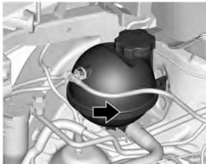
O reservatório de expansão de líquido de arrefecimento fica localizado no compartimento do motor no lado do passageiro do veículo. Consulte *Vista geral do compartimento do motor (Motor 1.0L L3 turbo)* ▷ 180 *Vista geral do compartimento do motor (Motor 1.0L L3)* ▷ 182.
