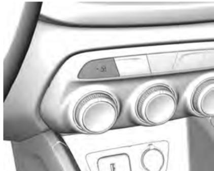
**🔒** : Pressione para travar as portas. A luz indicadora acenderá quando a porta for travada. Para destravar a porta, pressione o interruptor novamente.
