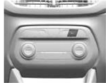
Se equipado, o botão **P**
