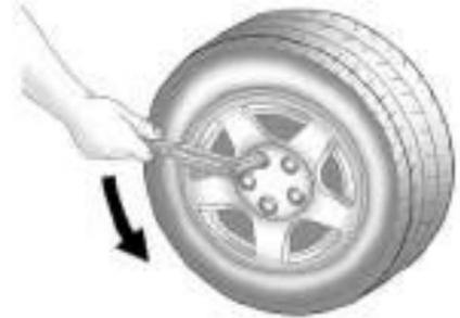
Instale a chave de roda assegurando-se de que ela esteja assentada de forma segura e afrouxe cada porca da roda meia volta.
