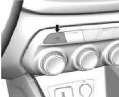
O veículo tem um sistema de alarme antifurto. A luz indicadora, integrada no interruptor das travas elétricas, indica o status do sistema.
