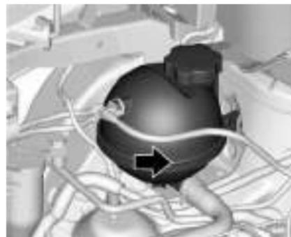
O reservatório de expansão de líquido de arrefecimento fica localizado no compartimento do motor no lado do passageiro do veículo. Consulte *Vista geral do compartimento do motor (Motor 1.0L L3 turbo)* ⇨ 168 *Vista geral do compartimento do motor (Motor 1.0L L3)* ⇨ 170.
