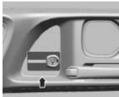
Coloque a chave não remota ou o controle remoto no console central ou no apoio de braço. As posições corretas são mostradas nas figuras.
