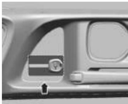
1. Coloque a chave ou o transmissor no console central ou dentro do apoio de braço como mostrado nas figuras.
