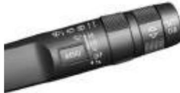
Com a ignição ligada ou em ACC/ACCESSORY, mova a alavanca do limpador do para-brisa para selecionar a velocidade do limpador.
