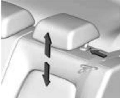
A altura do apoio de cabeça pode ser ajustada. Puxe o apoio de cabeça para levantá-lo. Tente mover o apoio de cabeça para se certificar de que ele está travado na posição.
