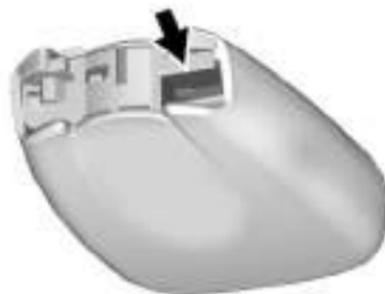
2. Separe as duas metades do transmissor usando uma ferramenta chata inserida na área próxima à fenda da chave.
