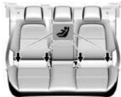
Este veículo é equipado com os suportes de montagem ISOFIX para instalação do dispositivo de retenção para crianças.
