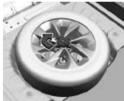
5. Coloque o pneu de tamanho normal danificado na cavidade do pneu reserva e aperte a porca borboleta.
