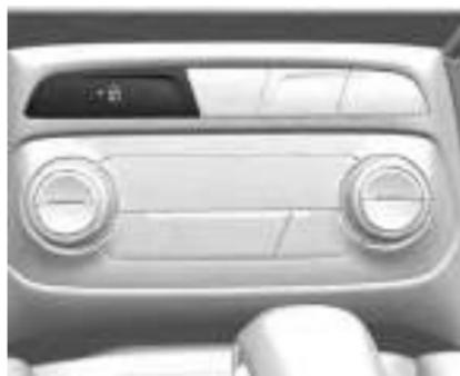
A luz indicadora, integrada no interruptor das travas elétricas, indica o status do sistema.
