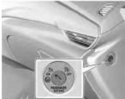
O sistema de airbag do passageiro pode ser desativado a partir de uma trava no painel de instrumentos, visível quando a porta dianteira do passageiro está aberta.
