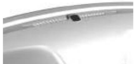
Há um sensor de iluminação na parte superior do painel de instrumentos. Não cubra o sensor.
