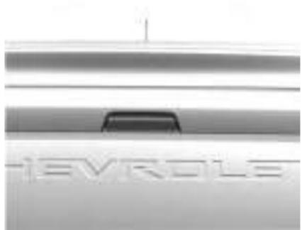
Para abrir a tampa do compartimento de carga, o veículo deve estar desligado ou parado, com a alavanca de mudança em P (Estacionamento), se equipado.
