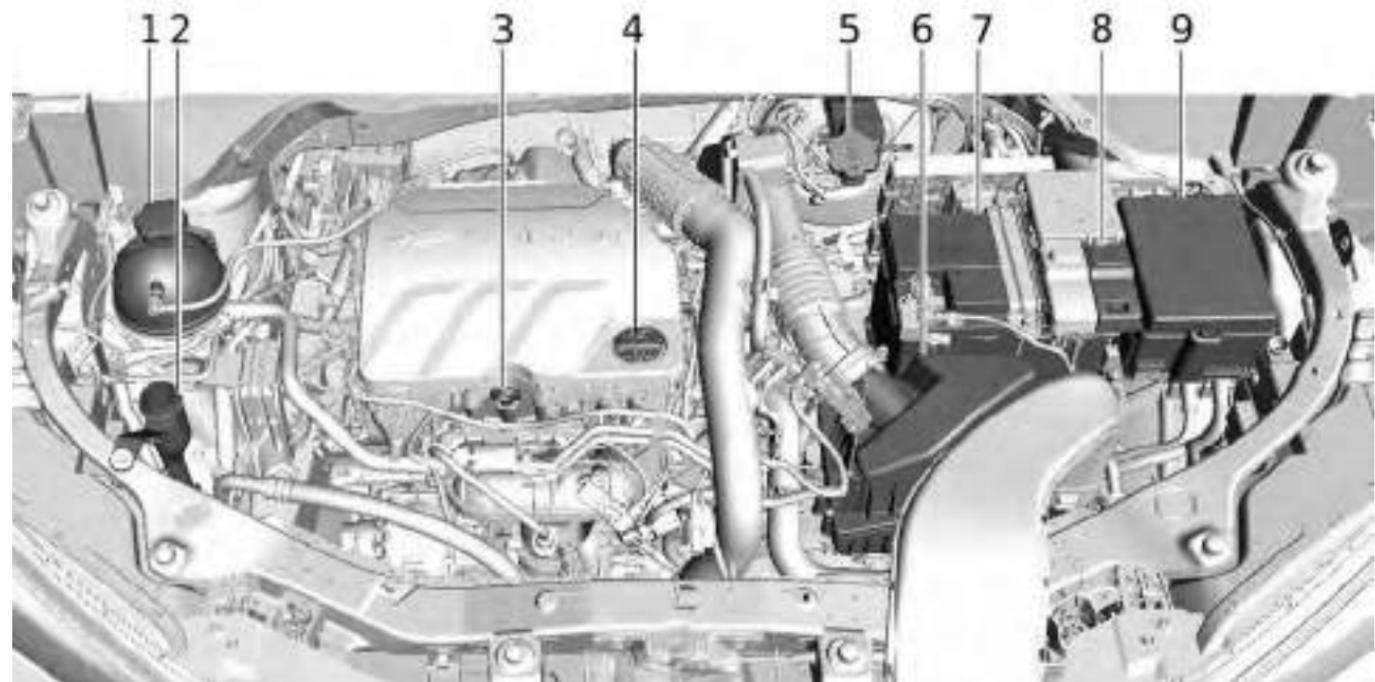
1. Reservatório do líquido de arrefecimento do motor.
