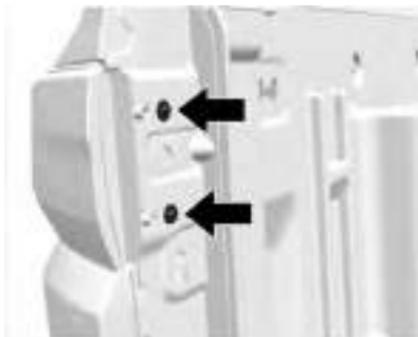
2. Remova os dois parafusos que prendem o conjunto da lanterna traseira na carroceria do veículo.
