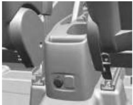
As tomadas elétricas acessórias podem ser usadas para conectar equipamentos elétricos, como um celular, carregadores de GPS ou qualquer outro dispositivo de 12 V que não exceda 120 W.
