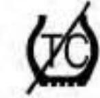
Essa luz acende brevemente ao dar a partida no motor. Se não acender, leve o veículo para reparos na concessionária. Se o sistema estiver funcionando normalmente, a luz indicadora se apagará.
