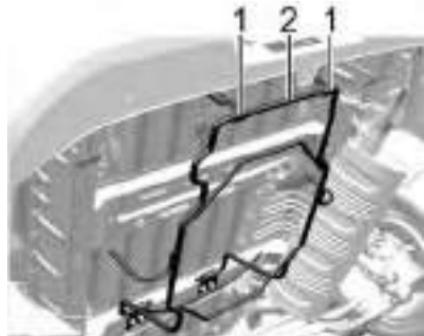
Inspeccione visualmente a gaiola e os ganchos para confirmar o armazenamento correto. Quando totalmente armazenado, a alça do suporte do pneu reserva (2) deverá estar ligeiramente acima da borda inferior da cobertura traseira. Os dois ganchos (1) deverá estar engatados no suporte e apertados. Deverá ser observado pouco movimento lateral ao aplicar uma força normal na alça.
