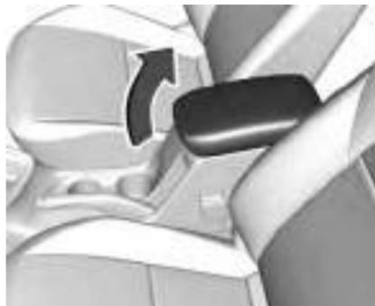
Se equipado, o console central que está localizado entre os bancos dianteiros possui um compartimento de carga. Pressione o botão para abri-lo.
