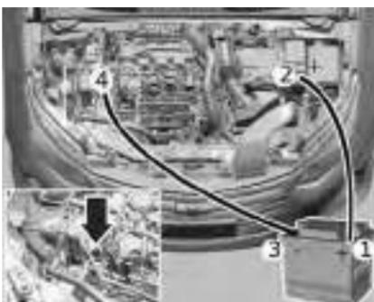
9. Conecte os cabos auxiliares na sequência indicada:
