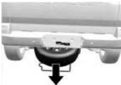
7. Levante ligeiramente a gaiola do pneu reserva e desengate as duas extremidades do gancho.
