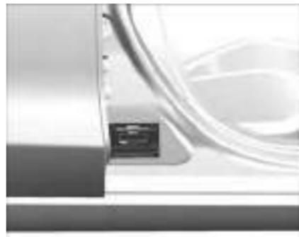
A plaqueta de identificação do veículo está localizada na coluna da porta dianteira direita.
