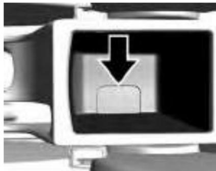
Coloque a chave não remota ou a chave eletrônica no console central ou no apoio de braço. As posições corretas são mostradas nas figuras.
