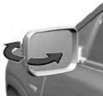
Para segurança do pedestre, os espelhos externos sairão da posição de montagem normal caso alguém colida com eles com força suficiente para isso. Reposite o espelho ao aplicar uma leve pressão na caixa do espelho. Essa função é útil também para reduzir a largura total do veículo e evitar danos quando o veículo estiver estacionado. Coloque o espelho de volta na posição funcional antes de dirigir.
