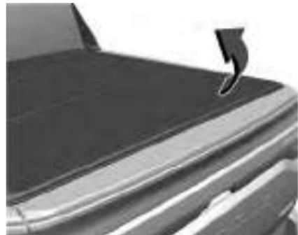
2. Puxe as alças para destravar a capota marítima, de modo que possa utilizar o compartimento de carga.
