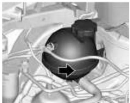
O reservatório de expansão de líquido de arrefecimento fica localizado no compartimento do motor no lado do passageiro do veículo. Consulte *Vista geral do compartimento do motor (Injeção direta)* ▷ 183.
