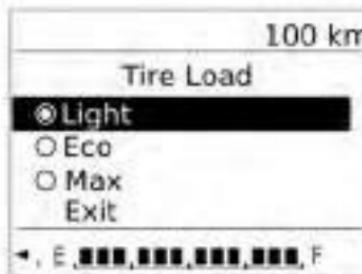
Para configurar a Carga dos pneus no menu do Centro de Informação do Motorista (DIC), pare o veículo e aplique o freio de estacionamento. Em veículos com transmissão automática, alterne para P (Estacionamento).
