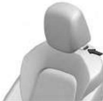
Puxe o apoio de cabeça para levantá-lo. Tente mover o apoio de cabeça para se certificar de que ele está travado na posição.
