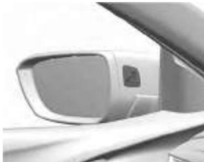
Quando a velocidade do veículo está acima de 10 km/h, o sistema de alerta de ponto cego lateral é ativado. Quando a velocidade do veículo for superior a 140 km/h, o sistema será desligado e a luz indicadora dos espelhos externos esquerdo e direito ficará esmaecida. Nesse momento, se a velocidade do veículo for reduzida, a luz indicadora do espelho desligará. Se for detectado um veículo no ponto cego nesse momento, a luz indicadora do espelho retrovisor correspondente acenderá.
