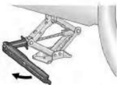
4. Levante o veículo girando a alavanca do macaco no sentido horário. Erga o veículo do chão o suficiente para que haja espaço para retirar o pneu de estrada do contato com o chão.
