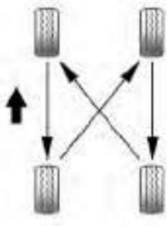
Forças diferentes nos pneus dianteiros e traseiros fazem com que eles se desgastem de forma diferente, dependendo de vários fatores, como a superfície da pista, a forma de condução, o alinhamento da suspensão, o balanceamento das rodas, a pressão dos pneus etc.
