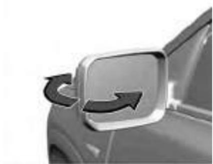
Para segurança do pedestre, os espelhos externos sairão da posição de montagem normal caso alguém colida com eles com força suficiente para isso. Reposite o espelho ao aplicar uma leve pressão na caixa do espelho. Essa função é útil também para reduzir a largura total do veículo e evitar danos quando o veículo estiver estacionado. Coloque o espelho de volta na posição funcional antes de dirigir.
