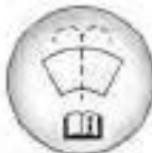
Abra a tampa com o símbolo de lavador. Complete o tanque com fluido do lavador. Consulte *Vista geral do compartimento do motor* ▷ 158 *Vista geral do compartimento do motor (Injeção direta)* ▷ 160 para ver o local do reservatório.
