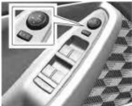
Se equipado, o controle dos espelhos elétricos se localiza no acabamento da porta do lado do motorista.
