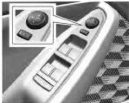
Se equipado, o controle dos espelhos elétricos se localiza no acabamento da porta do lado do motorista.
