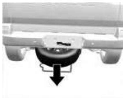
7. Levante ligeiramente a gaiola do pneu reserva e desengate as duas extremidades do gancho.
