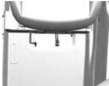
Se equipado, o veículo tem uma localização correta para instalar o extintor de incêndio, abaixo do banco do motorista. O extintor de incêndio e as presilhas de suporte podem ser adquiridas e instaladas nas concessionárias.
