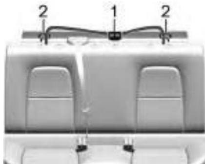
O top tether é encaminhado através de anéis (2) para a ancoragem top tether (1). Certifique-se de ler as instruções abaixo para instalar corretamente um dispositivo de retenção para crianças usando esses anéis e ancoragens.
