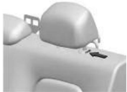
Para abaixar o apoio de cabeça, pressione o botão, localizado na parte superior do encosto do banco, e pressione para baixo o apoio de cabeça.
