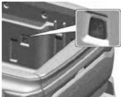
Se equipado, a luz externa do compartimento de carga se localiza no painel lateral interno e tem a função de iluminar a área do compartimento de carga.
