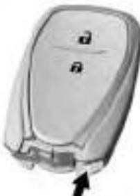
2. Separe as duas metades do transmissor usando uma ferramenta chata inserida na área próxima à fenda da chave.
