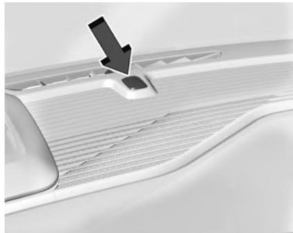
Quando o cabo do carregador está conectado, uma cor aparece para indicar o status do carregamento.
