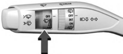
Com o veículo ligado, mova a alavanca do limpador do para-brisa para selecionar a velocidade do limpador.
