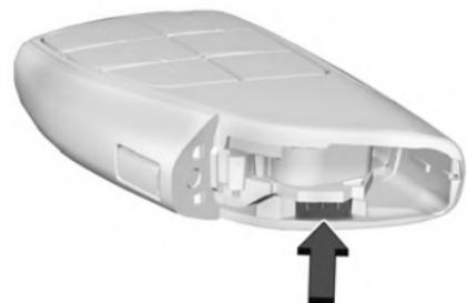
2. Use a lâmina da chave mecânica na ranhura para remover a tampa da bateria.
