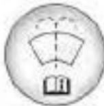
Abra a tampa com o símbolo de lavador. Complete o tanque com fluido do lavador.
