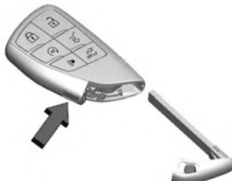
Para remover a chave mecânica, pressione o botão próximo da parte inferior da chave remota e puxe a chave para fora. Nunca puxe a chave mecânica sem pressionar o botão.
