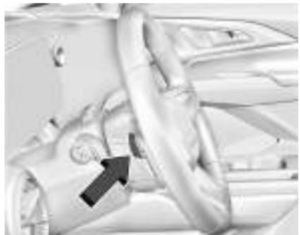
A regeneração sob pedido permite uma maior desaceleração pressionando e mantendo pressionado a alavanca do volante. A Regeneração sob pedido funciona em D (Drive). O pedal do acelerador pode ser usado para gerenciar a desaceleração enquanto usa a Regeneração sob pedido. Consulte *Condução com um pedal* ▷ 174.
