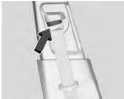
Pressione o botão de liberação e mova o ajustador de altura para a posição desejada. O regulador pode ser movido para cima empurrando para cima o controle deslizante/ acabamento. Depois de regulado na posição correta, tente mover o ajustador para baixo sem pressionar o botão de destravamento para certificar-se de que esteja travado na posição.
