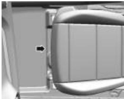
O veículo tem uma localização correta para instalar o extintor de incêndio, abaixo do banco dianteiro do passageiro, sob o carpete do piso. O extintor de incêndio e as presilhas de suporte podem ser adquiridas e instaladas em concessionárias Chevrolet.
