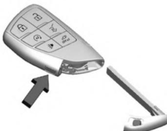
1. Pressione o botão na lateral da chave remota próximo à parte de baixo e retire a chave mecânica. Nunca puxe a chave mecânica sem pressionar o botão.
