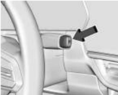
Esta posição trava as rodas motrizes. Use P (Estacionamento) ao ligar o veículo para assegurar que o veículo não se mova.
