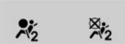
Quando o veículo for ligado, o indicador de status do airbag do passageiro acenderá os símbolos para ligar e desligar, por vários segundos, como uma verificação do sistema. Em seguida, após mais alguns segundos, o indicador de status acenderá o símbolo de ligado ou desligado para informá-lo sobre o status do airbag de joelho e do airbag do passageiro dianteiro.
