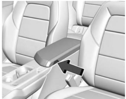
Há um compartimento de carga no console central. Levante a alavanca na lateral para abrir.
