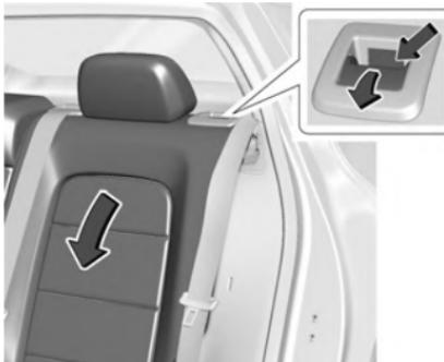
1. Puxe a alavanca na parte superior do encosto para destravá-lo. Uma lingueta próxima à alavanca do encosto levanta ao destravar o encosto.
