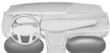
O airbag de joelho do motorista está embaixo da coluna de direção. O airbag de joelho do passageiro dianteiro está abaixo do portaluvas.
