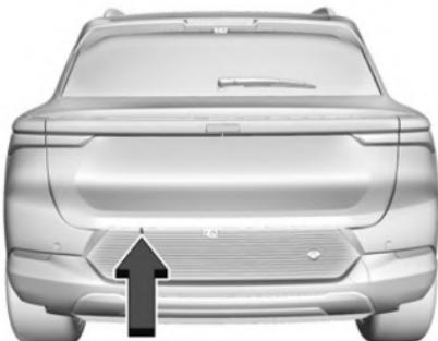
Para acessar o cilindro da trava da chave da tampa do porta-malas, insira a chave mecânica no cilindro e gire para destravar. Consulte *Chaves* ▷ 6.
