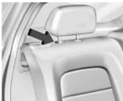
Para abaixar o apoio de cabeça, pressione o botão, localizado na parte superior do encosto do banco, e pressione para baixo o apoio de
