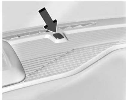
O sensor de iluminação fica na parte superior do painel de instrumentos. Não cubra o sensor.
