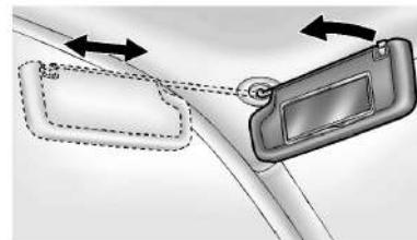
Puxe o para-sol para baixo para bloquear o ofuscamento. Desprenda o para-sol do suporte central para girar para o vidro lateral e, se equipado, estendê-lo ao longo da haste.
