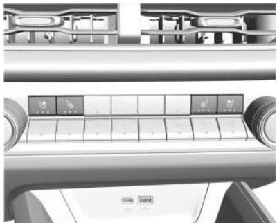
Se disponível, os botões estão próximos do Sistema de ventilação e de ar condicionado no console central. O motor deverá estar funcionando para ligar.
