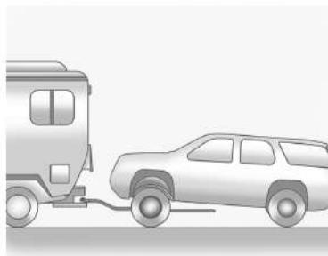
Para rebocar o veículo na dianteira com as rodas traseiras no solo:
