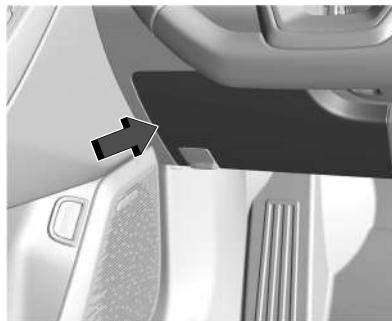
A caixa de fusíveis do painel de instrumentos fica dentro do console central no lado do passageiro do veículo.
