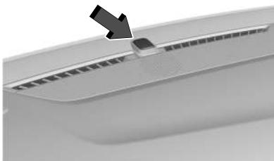
O sensor de luz solar, na parte superior do painel de instrumentos próximo ao para-brisa, monitora o calor solar.
