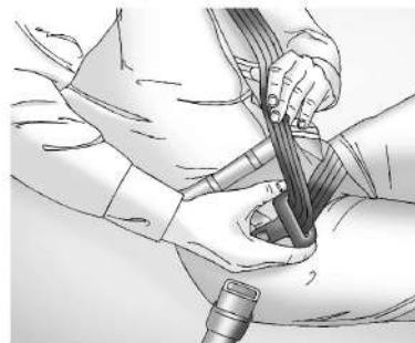
Se a correia travar na lingueta do fecho antes de chegar na fivela, incline a lingueta do fecho na horizontal para destravar.
