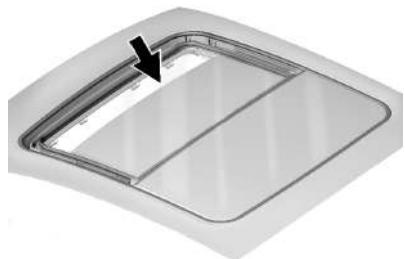
A sujeira e detritos podem se acumular na vedação do teto solar ou no trilho. Isto poderá causar um problema no funcionamento ou ruído no teto solar. Isto também poderá obstruir o sistema de drenagem de água. Abra periodicamente o teto solar e remova qualquer obstáculo ou detrito solto. Limpe a vedação do teto solar e a área de vedação usando um pano limpo, sabão suave e água. Não remova a graxa do teto solar.
