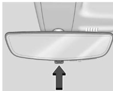
Puxe a aba para ligar o visor. Pressione a aba para desligar. Quando o espelho está desligado, possui antifuscamento automático. Regule o espelho para uma visão clara da área atrás do veículo enquanto o visor está desligado.
