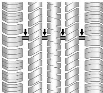
Indicadores de desgaste do sulco são uma maneira de informar quando é hora de colocar pneus novos. Indicadores de desgaste dos sulcos aparecem quando os pneus têm apenas 1,6 mm (1/16 in) ou menos restante de sulco. Consulte *Inspeção dos pneus* ▷ 270 e *Rodízio dos pneus* ▷ 271.
