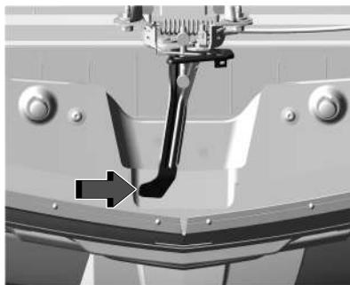
2. Vá para a frente do veículo e localize a alavanca de liberação secundária sob a parte central frontal do capô. Empurre a alavanca de liberação secundária do capô para a direita para liberar.
