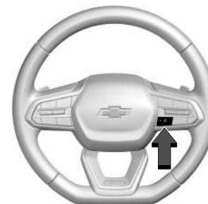
: Se equipado com volante aquecido, pressione para ligar ou desligar. Uma luz perto do botão mostra quando a função está ligada. O volante leva cerca de três minutos para iniciar o aquecimento.
