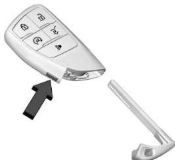
Para remover a chave mecânica, pressione o botão na lateral da chave remota e puxe a chave mecânica para fora. Nunca puxe a chave mecânica sem pressionar o botão.
