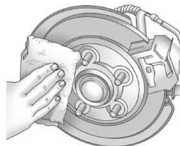
13. Remova ferrugem ou sujeira dos parafusos da roda, das superfícies de montagem e do pneu reserva.
