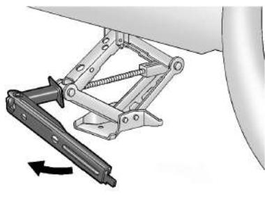
10. Levante o veículo girando a alavanca do macaco no sentido horário. Erga o veículo do chão o suficiente para que haja espaço para retirar o pneu de estrada do contato com o chão.
