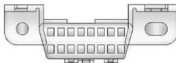
O DLC está em baixo do painel de instrumentos, no lado esquerdo do volante. Dispositivos de conexão que não são usados para realizar um teste de manutenção/inspeção de emissões ou para reparar o veículo podem afetar o funcionamento do veículo. Consulte Equipamento Elétrico Adicional. Consulte sua concessionária se precisar de assistência.
