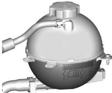
3. Abasteça o reservatório de expansão de líquido de arrefecimento com a mistura adequada até a marca de nível indicada.
