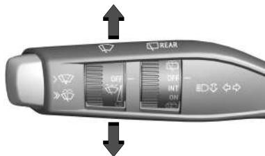
Mova a alavanca totalmente para cima ou para baixo para sinalizar uma alteração de direção.
