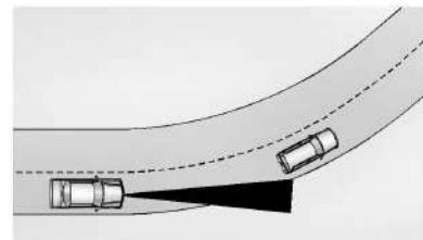
Quando estiver seguindo um veículo e entrar em uma curva, o ACC poderá não detectar o veículo à frente e acelerar até a velocidade configurada. Quando isso acontece, o indicador de veículo à frente não aparecerá.
