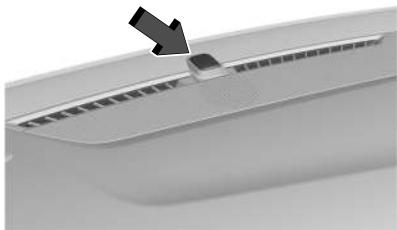
A luz indicadora, no painel de instrumentos próximo do para-brisa, indica o status do sistema.
