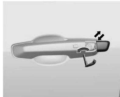
1. Insira a chave na ranhura da parte inferior da maçaneta junto à tampa do cilindro da chave.
