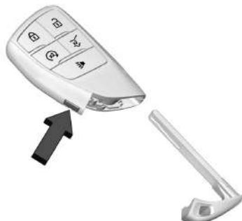
1. Pressione o botão na lateral da chave remota próximo à parte de baixo e retire a chave mecânica. Nunca puxe a chave mecânica sem pressionar o botão.
