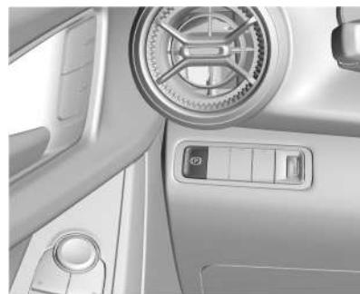
O freio de estacionamento elétrico (EPB) sempre pode ser aplicado, mesmo com o veículo desligado. Em caso de energia elétrica insuficiente, o EPB não pode ser acionado nem liberado. Para evitar o esgotamento da bateria, evite ciclos repetidos desnecessários do EPB.
