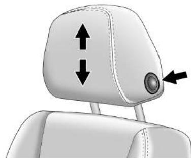
Para levantar ou abaixar o apoio de cabeça, pressione o botão localizado na lateral do apoio de cabeça e puxe-o para cima ou empurre o apoio de cabeça para baixo, e solte o botão. Puxe e empurre o apoio de cabeça depois que o botão for liberado, para se certificar de que ele esteja travado na posição.
