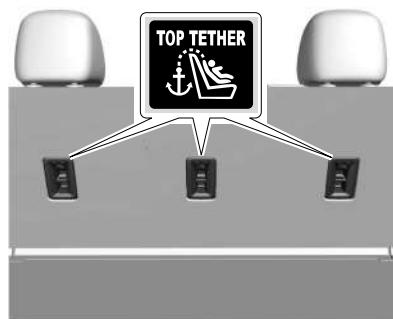
Os pontos de ancoragem do cabo superior ficam localizados na parte de trás dos encostos dos bancos da segunda fila e são sempre alinhados com os bancos traseiros, e identificados com o símbolo
