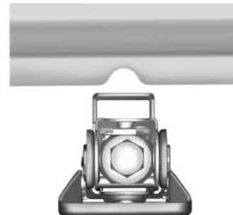
9. Posicione a cabeça do macaco no local mais próximo ao pneu furado. A localização é indicada por um entalhe na borda inferior vertical da folha de metal lateral do corpo.
