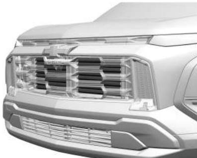
O veículo pode ter um sistema de obturador projetado para auxiliar na economia de combustível. Mantenha o sistema de obturador isento de detritos, neve e gelo. Se a luz Verificar motos estiver ativada, verifique se o sistema do obturador está isento de detritos, neve ou gelo.
