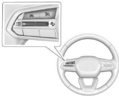
: Pressione para ligar e desligar o controle de velocidade de cruzeiro. O indicador do controle de velocidade de cruzeiro ficará branco no painel de instrumentos quando o controle de velocidade de cruzeiro for ativado.
