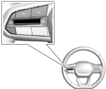
: Pressione para ligar ou desligar o sistema. O indicador fica branco no painel de instrumentos quando o ACC é ativado.
