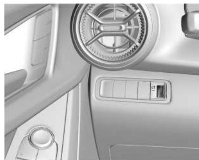
Este recurso ajusta a luminosidade de todos os controles iluminados. O controle de iluminação do painel de instrumentos está próximo do controle das luzes externas.
