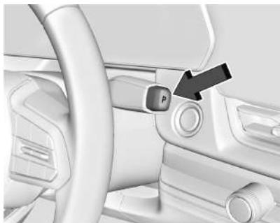
**P:** Esta posição trava as rodas motrizes. Use P (Estacionamento) ao ligar o veículo para assegurar que o veículo não se move.
