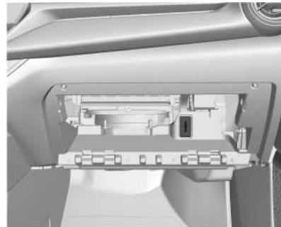
O status do cartão SD deve ser destravar. Insira o cartão SD no leitor de cartão atrás do compartimento de instrumentos. Desligue a ignição e aguarde 20 minutos após inserir o cartão SD no leitor. Ligue a ignição e toque no ícone Gravador na Tela do Conforto e Conveniência.
