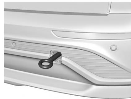
2. Instale o gancho do reboque no soquete e gire-o até estar totalmente apertado. Quando o gancho de reboque for removido, recoloque a tampa com a ranhura na posição original.
