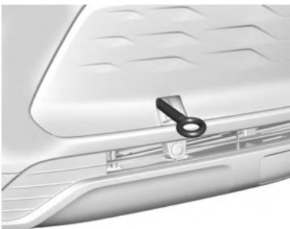
2. Instale o gancho do reboque no soquete e gire-o até estar totalmente apertado. Quando o gancho de reboque for removido, recoloque a tampa com a ranhura na posição original.
