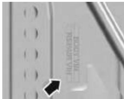
O ano de fabricação do veículo está localizado no VIN do veículo, sob o assento do passageiro dianteiro.
