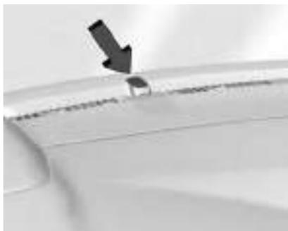
Quando o cabo do carregador está conectado, uma cor aparece para indicar o status do carregamento.
