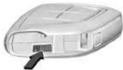
2. Separe as duas metades da chave remota usando a lâmina da chave mecânica inserida na parte inferior central da chave remota. Não use o compartimento da chave.
