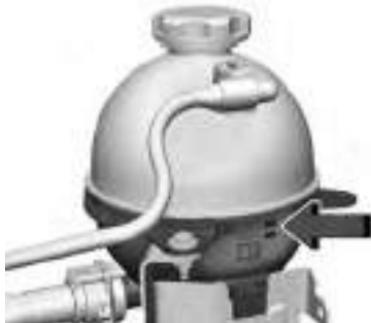
5. Se o nível do líquido de arrefecimento não estiver visível ou precisar ser ajustado dentro do reservatório, entre em contato com a concessionária.
