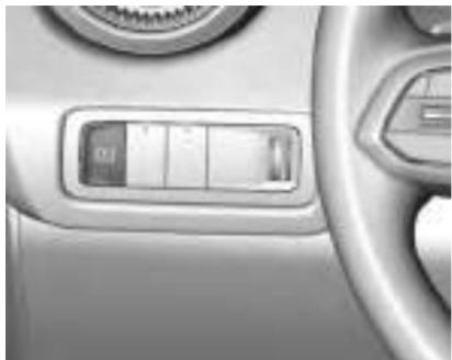
O freio de estacionamento elétrico (EPB) sempre pode ser aplicado, mesmo com o veículo desligado. Em caso de energia elétrica insuficiente, o EPB não pode ser acionado nem liberado. Para evitar o esgotamento da bateria, evite ciclos repetidos desnecessários do EPB.
