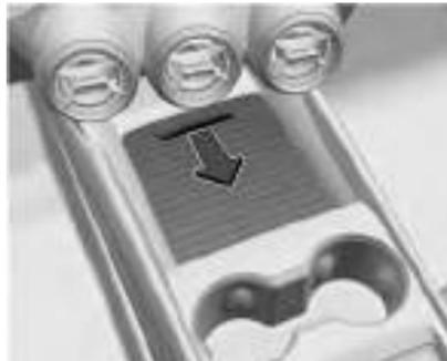
Para abrir o compartimento de carga dianteiro, deslize a tampa para frente. Há duas portas USB em seu interior. Para fechar, empurre a tampa para frente e solte-a.
