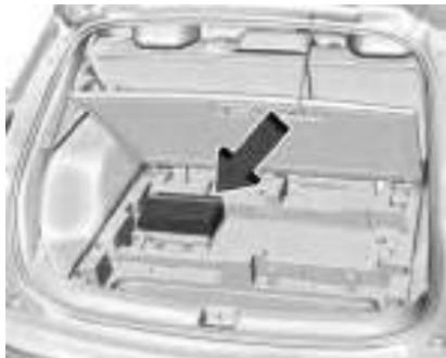
3. Solte a alça que prende o Kit de composto de vedação para pneu e compressor e, em seguida, remova o kit.
