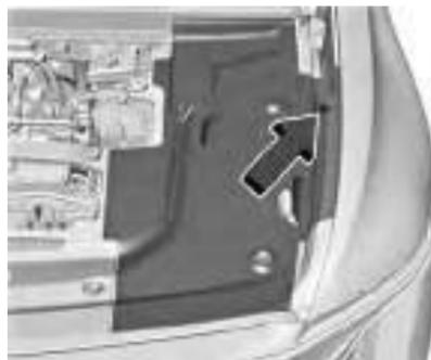
2. O bloco de fusíveis do compartimento sob o capô está sob uma tampa e uma extensão / proteção lateral no compartimento sob o capô. Solte o lado direito da proteção e remova a tampa de acesso do lado direito.
