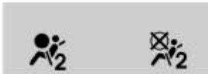
Quando o veículo for ligado, o indicador de status do airbag do passageiro acenderá os símbolos para ligar e desligar, por vários segundos, como uma verificação do sistema. Em seguida, após mais alguns segundos, o indicador de status acenderá o símbolo de ligado ou desligado para informá-lo sobre o status do airbag de joelho e do airbag do passageiro dianteiro.
