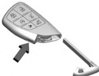
Para remover a chave mecânica, pressione o botão na lateral da chave remota e puxe a chave mecânica para fora. Nunca puxe a chave mecânica sem pressionar o botão.
