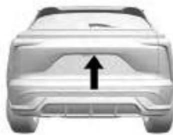
Para abrir a tampa do porta-malas, pressione no interruptor da trava elétrica das portas ou pressione duas vezes na chave remota para destravar todas as portas.
