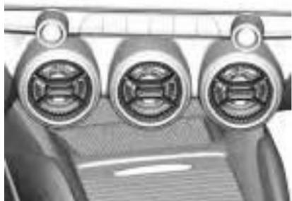
Use as saídas de ar no centro e na lateral do painel de instrumentos para direcionar o fluxo de ar. Gire os botões centrais das saídas de ar no sentido anti-horário ou horário para abrir ou fechar o fluxo de ar.
