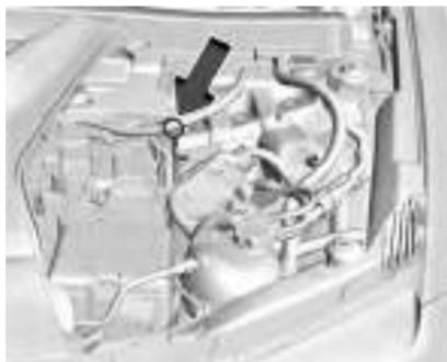
3. Puxe a alavanca manual de emergência para liberação do cabo de recarga. O cabo de recarga será liberado.
