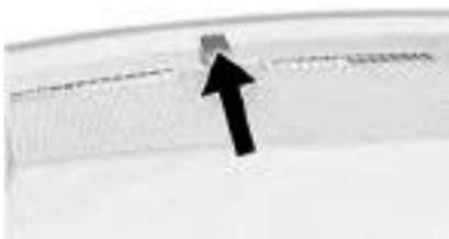
O sensor solar, na parte superior do painel de instrumentos próximo ao para-brisa, monitora o calor solar.
