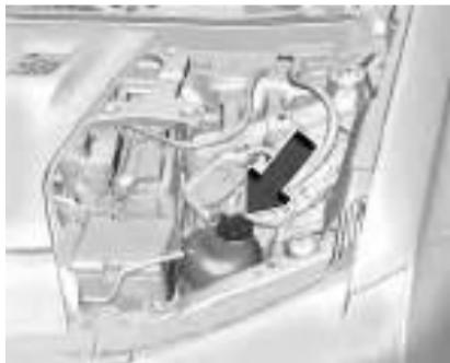
4. Depois que o sistema tiver esfriado completamente, verifique o nível do líquido de arrefecimento no reservatório.
