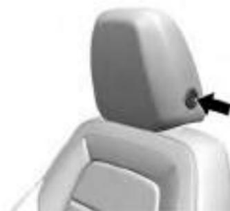
Para levantar ou abaixar o apoio de cabeça, pressione o botão localizado na lateral do apoio de cabeça e puxe-o para cima ou empurre o apoio de cabeça para baixo, e solte o botão. Puxe e empurre o apoio de cabeça depois que o botão for liberado, para se certificar de que ele esteja travado na posição.
