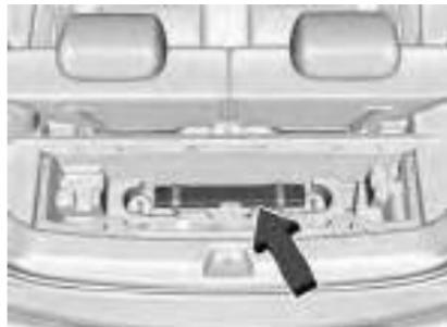
O triângulo de segurança é armazenado na parte traseira do veículo, sob o assoalho de carga.
