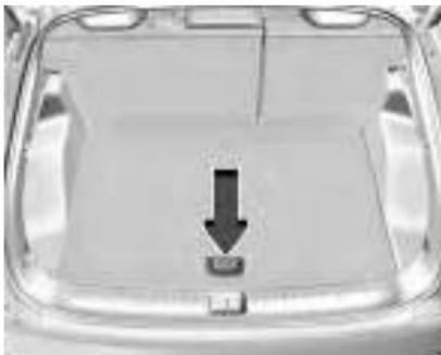
3. Abra a tampa do porta-malas, levante a cobertura do assoalho do porta-malas e remova o cabo de carga para **carregador portátil**.
