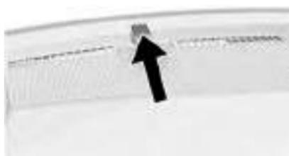
Há um sensor de iluminação na parte superior do painel de instrumentos. Não cubra o sensor.
