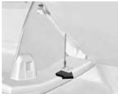
3. Solte o amortecedor de fios para remover completamente o compartimento do porta-luvas.
