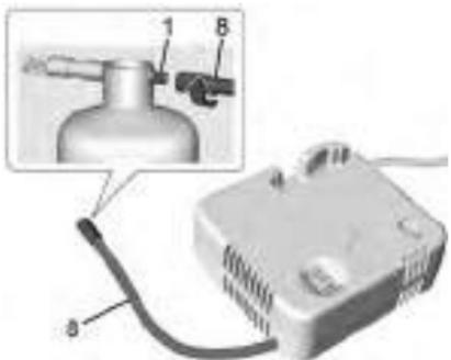
4. Remova a tampa da válvula de entrada do canister de selante (1) girando-a no sentido anti-horário. Prenda a mangueira apenas para ar (8) na válvula de entrada do canister do composto de vedação (1) girando no sentido horário até apertar.
