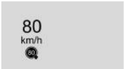
**Visualização da velocidade :** Se equipado e ativo, exibe a leitura do velocímetro em unidades imperiais ou métricas e o limite de velocidade indicado.
