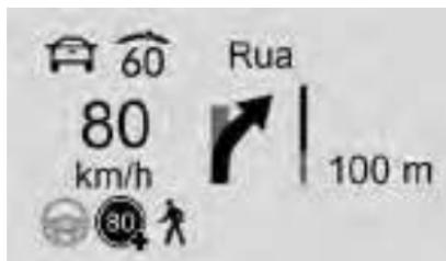
**Visualização de navegação :** Exibe a tela de velocidade juntamente com os indicadores para veículo à frente, alerta de mudança de faixa / assistente de permanência na faixa, oscilação do reboque e informações sobre pedestres. As informações de Navegação curva a curva são exibidas durante a rota ativa. A indicação da bússola é exibida quando a rota de navegação não está ativa.
