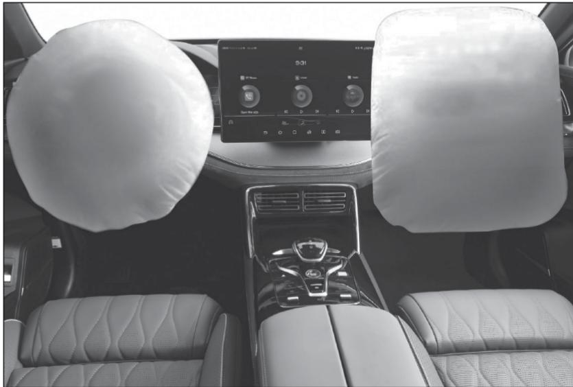
Caso a ECU do sistema de proteção complementar identifique uma condição de colisão frontal de gravidade média a severa durante a condução do veículo e as condições de acionamento dos airbags dianteiros sejam satisfeitas, os airbags serão acionados para reduzir o risco ou a gravidade de ferimentos.
