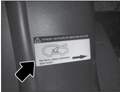
A etiqueta de abertura do capô está colada na parte inferior da coluna dianteira, no lado interno, localizada ao lado esquerdo da alavanca de abertura do capô.
