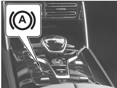
O sistema de freio de estacionamento automático foi projetado para imobilizar o veículo sem a necessidade de manter o pedal de freio pressionado ou acionar o freio de estacionamento, enquanto o veículo necessita permanecer parado por algum tempo, como por exemplo, em semáforo ou no andar e para do trânsito.
